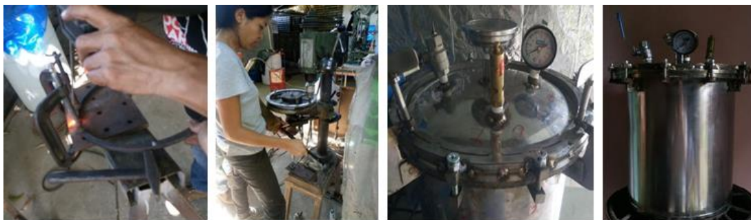
Figura 91. Construcción de los aros, rectificado, colocación del mecanismo de cierre y accesorios y resultado final.
