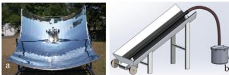
Figura 33. a) Esterilizador con colector solar parabólico. b) Equipo de esterilización mediante tubo colector.
