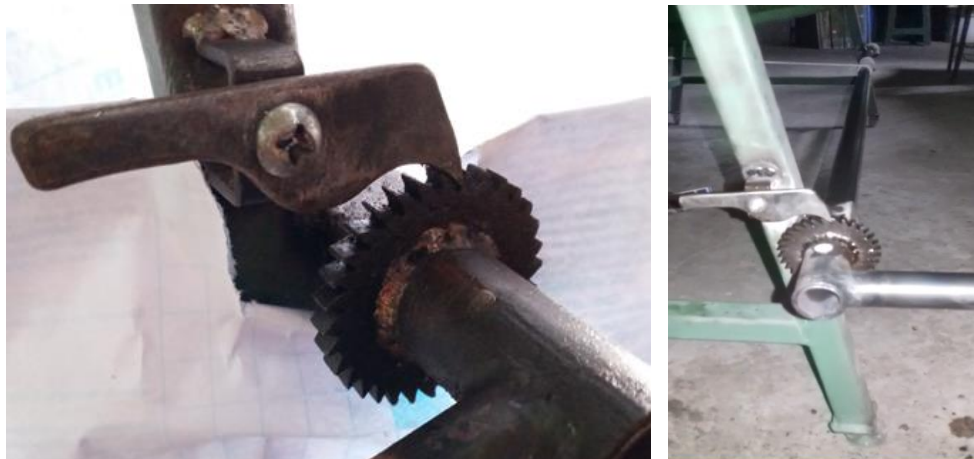
Figura 87. Rueda dentada para el bloqueo de posición y el rodillo.
