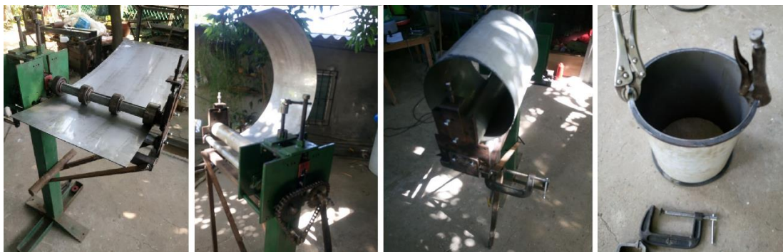
Figura 88. Secuencia del doblado de la lámina y aprisionamiento con los aros guías para la obtención del cuerpo cilíndrico.
