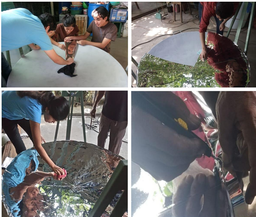
Figura 84. Colocación de la película reflectiva Reflectech.
