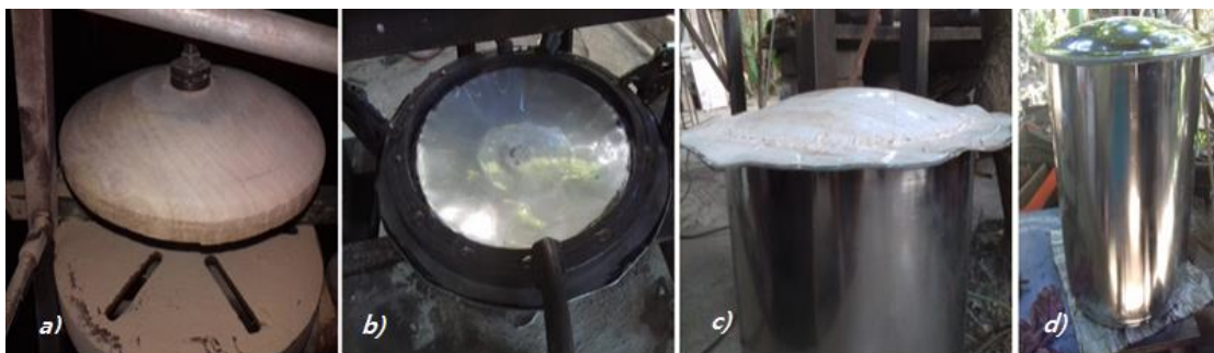
Figura 90. Secuencia constructiva: a) Molde positivo, b) molde negativo, c) resultado tras el conformado y d) el recipiente finalizado.
