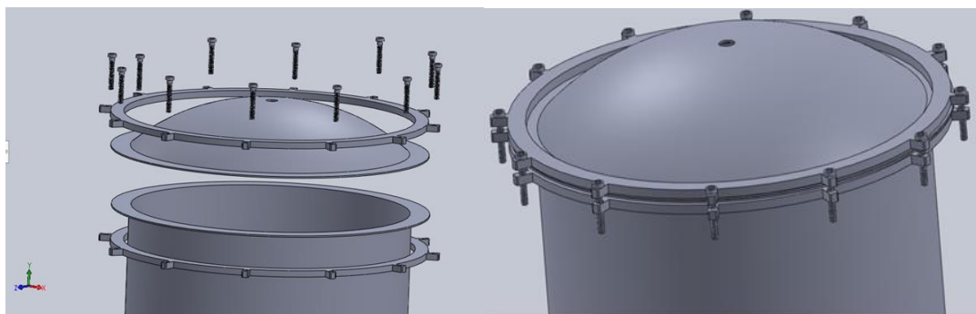
Figura 50. Mecanismo de cierre del recipiente esterilizador.
