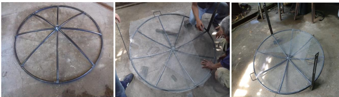
Figura 82. Armazón del concentrador y colocación de la malla.
