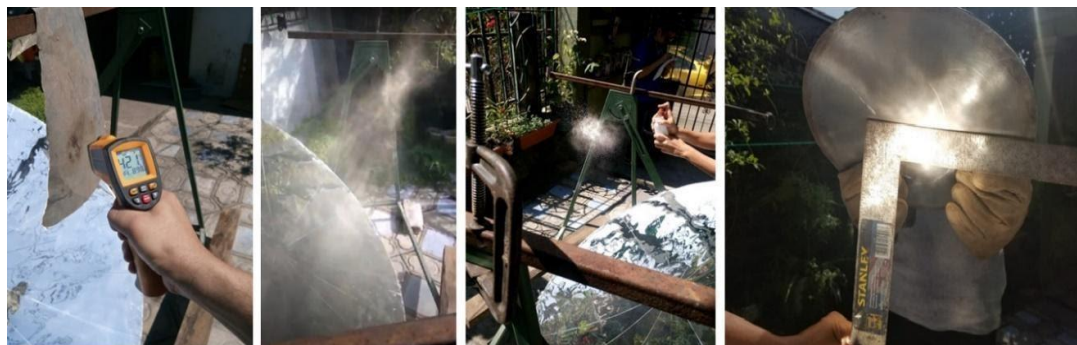
Figura 98. Prueba de temperatura máxima, ubicación del punto focal y medición de la imagen proyectada.
