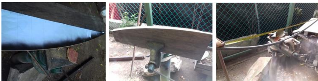
Figura 80. Obtención del molde con el perfil parabólico y uno de los brazos del concentrador.
