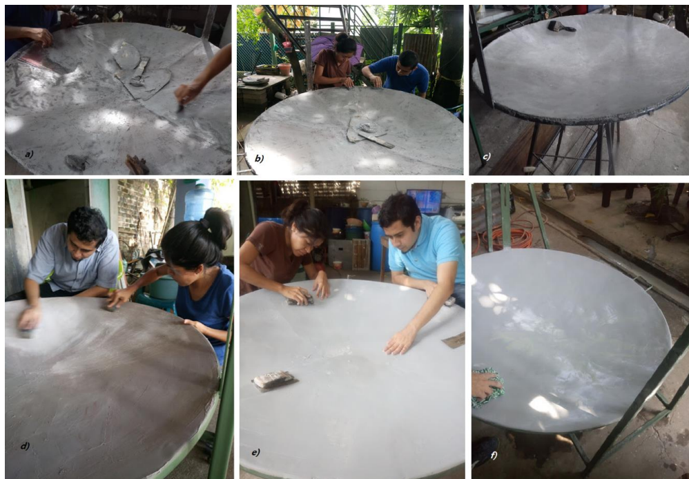
Figura 83. Aplicación de la masilla para la generación de la superficie (a,b,c). Corrección y acabado final de la superficie (d,e,f).
