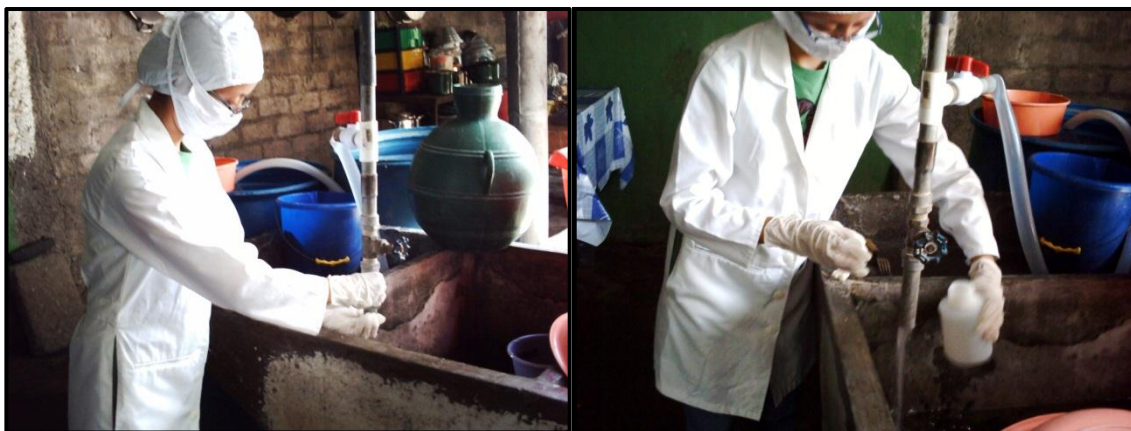
Figura N° 12. Toma de muestra de agua de pozo con bomba.
