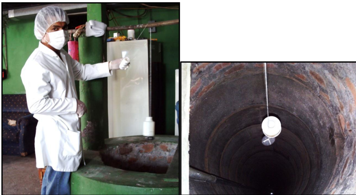
Figura N° 13. Toma de muestra de agua de pozo sin bomba.
