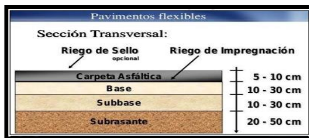
Figura 2: 2.2 Estructura típica de un pavimento
