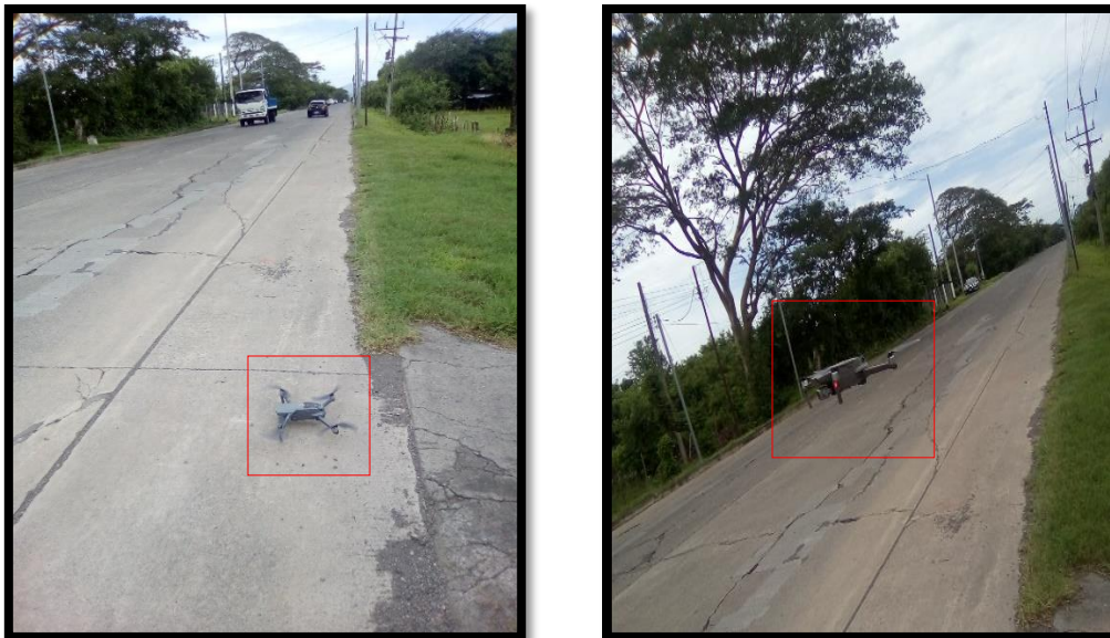
Figura 86: 4.2 Despegue del VANT desde el hombro de la calzada
