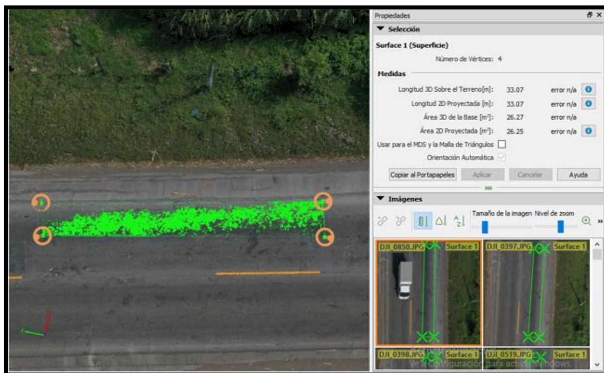
Figura 53: 3.40 Medición de área de falla tipo parche en Pix4D Mapper en el modelo digital 3D
