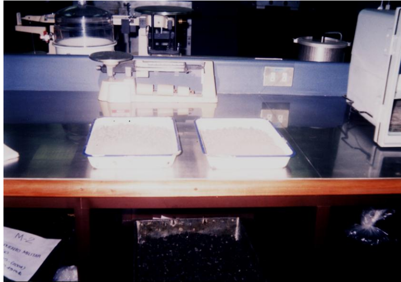
Figura 4.6. Muestra separada del asfalto, es a la que se toma la granulometría.
