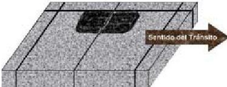
Fig. 3.6 Fisura por reflexión de junta.
