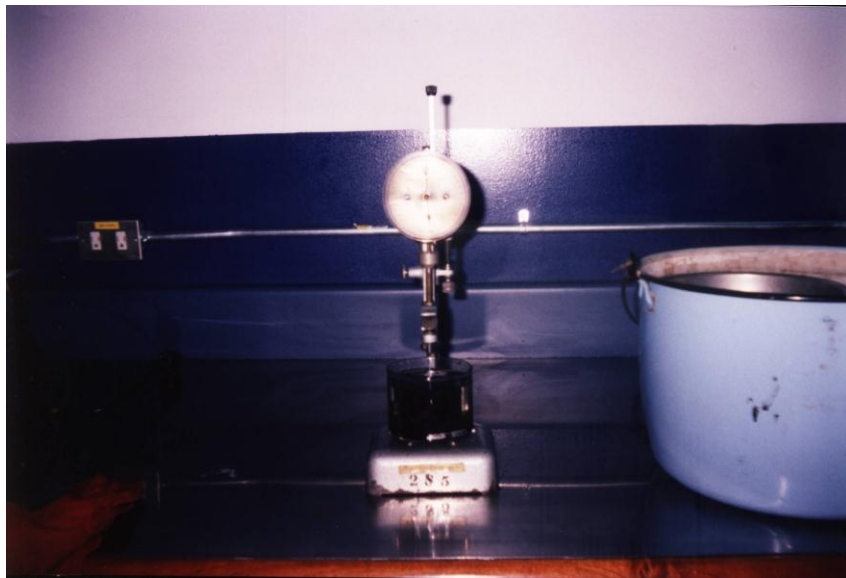
Figura 4.11. Equipo para determinar la Penetración del Asfalto. Normada por ASTM D 5 Marca: Soiltest, Inc.
