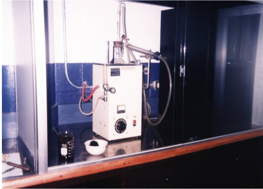
Figura 4.9. Equipo para extracción del asfalto, es decir separa el asfalto del solvente. Marca: Fressia Macross
