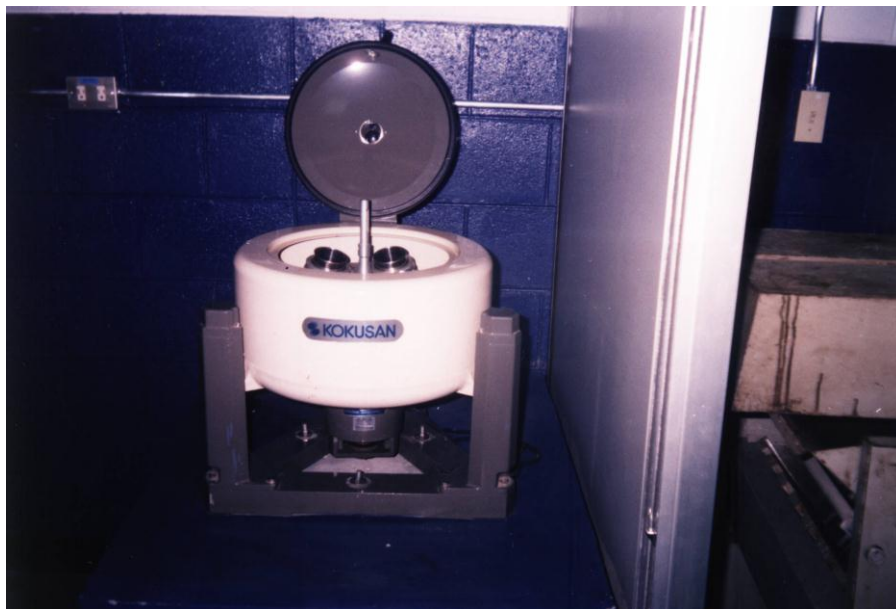
Figura 4.8 Aparato centrífugo, separa los agregados finos del asfalto-solvente. Marca: Fressia Macross
