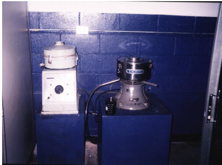
Figura 4.7. Extractores Centrífugos, separa los agregados del asfalto con solvente tricloroetileno. Marca: Soiltest, Inc. (izquierda) y Freesia Macross (derecha).
