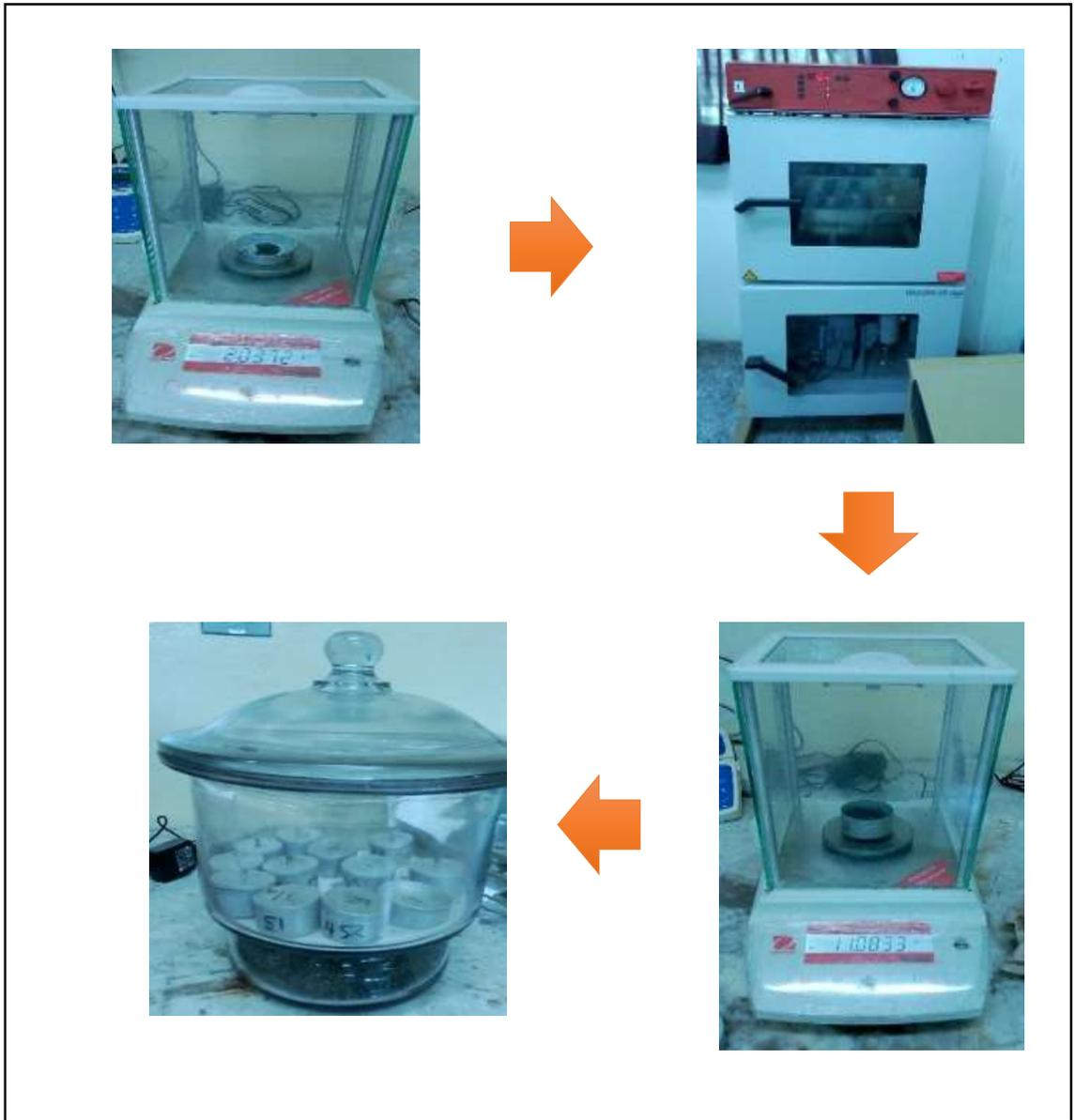
Figura N° 14. Determinación del porcentaje de humedad por el método gravimétrico
