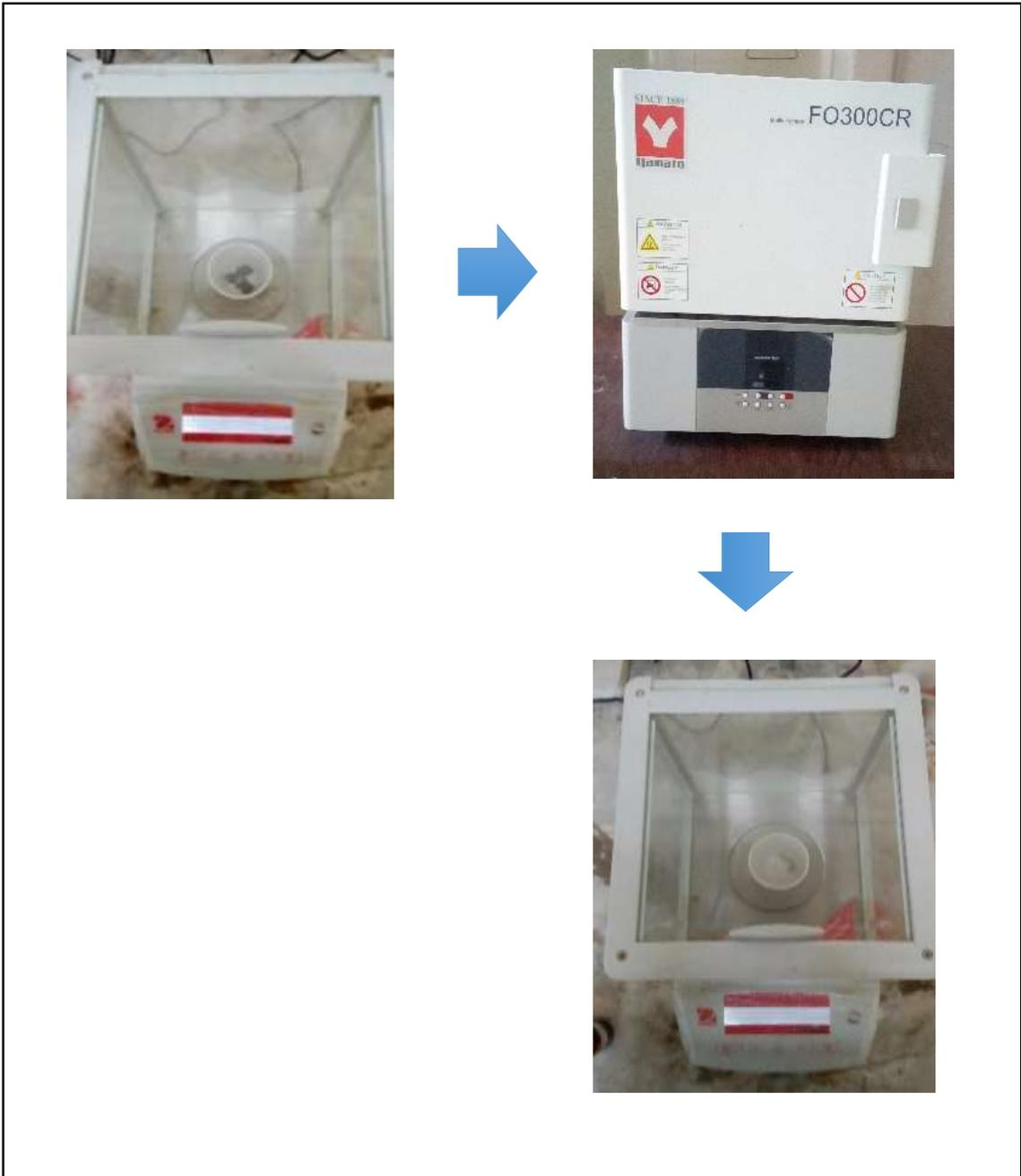
Figura N° 15. Determinación del porcentaje de cenizas por el método gravimétrico
