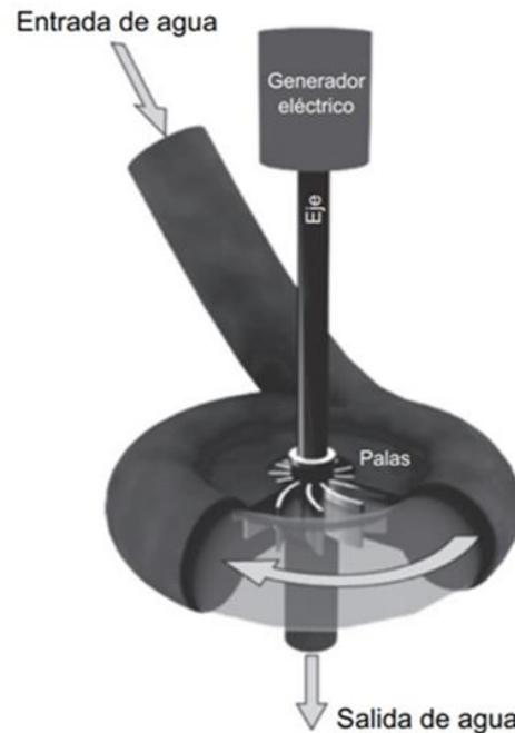
Figura 82. Esquema de una turbina Francis.
