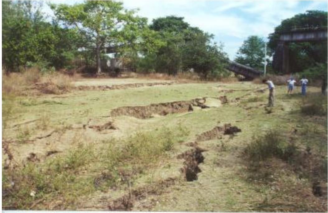
Fig. 2. 96 Agrietamiento del suelo producido por los sismos del 2001 cerca del río Lempa, en la zona de San Nicolás Lempa (Bommer, J. y otros 2001).
