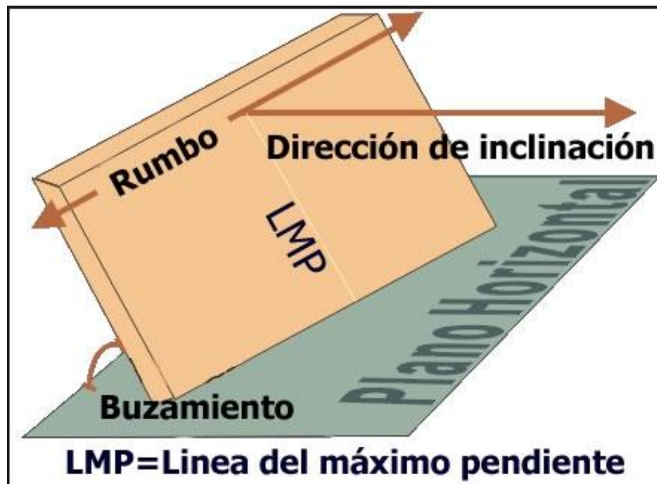
Fig. 1. 9 Características de una falla ( http://www.funvisis.gob.ve/mecanismos_focales.php ).
