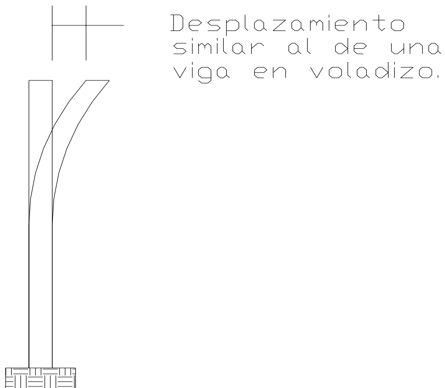
Fig. 2. 29 Desplazamiento de una pared de concreto reforzado sometido a flexión.
