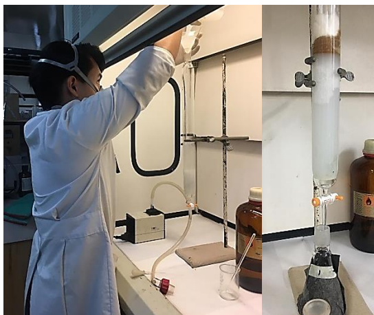
Figura N°47. Preparación de la columna cromatográfica. Propiedad del LIPN.
