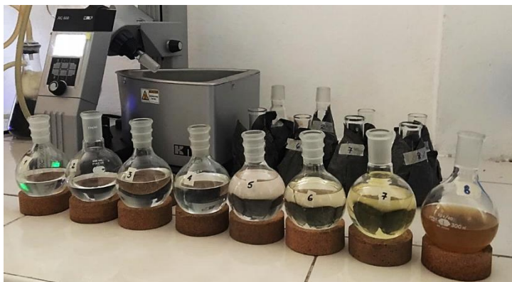
Figura N°48. Fracciones obtenidas de la cromatografía en columna en orden creciente de polaridad de izquierda a derecha. Propiedad del LIPN.
