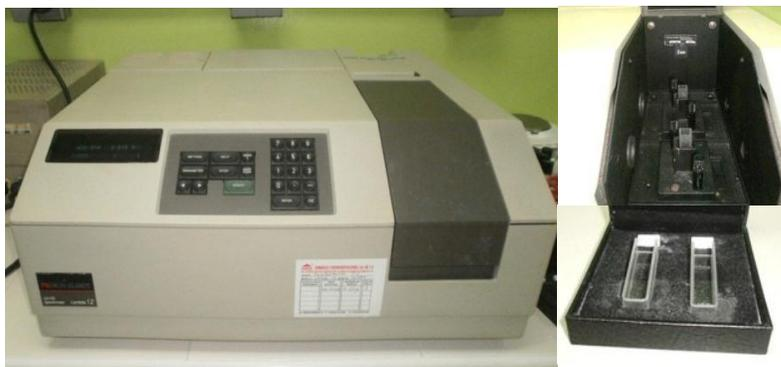
Fig. N° 15 Espectrofotómetro UV-Vis. (Perkin Elmer/Lambda 12)
