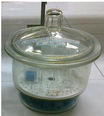
Fig. N° 7 Preparación de Equipo y colocación en Desecador.
