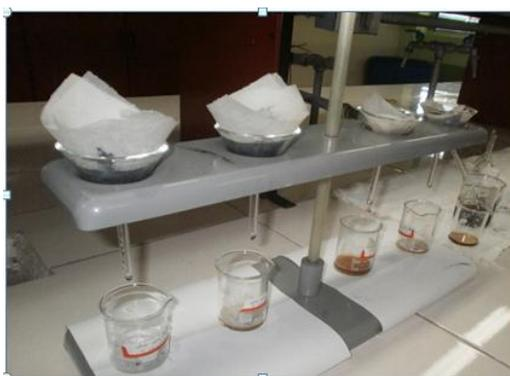
Fig. N° 8 Proceso de Filtración de Bebidas de Cola.
