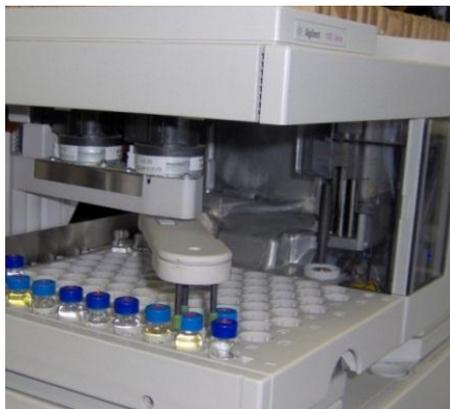
Fig. N° 17 Inyección de muestras en el Equipo HPLC
