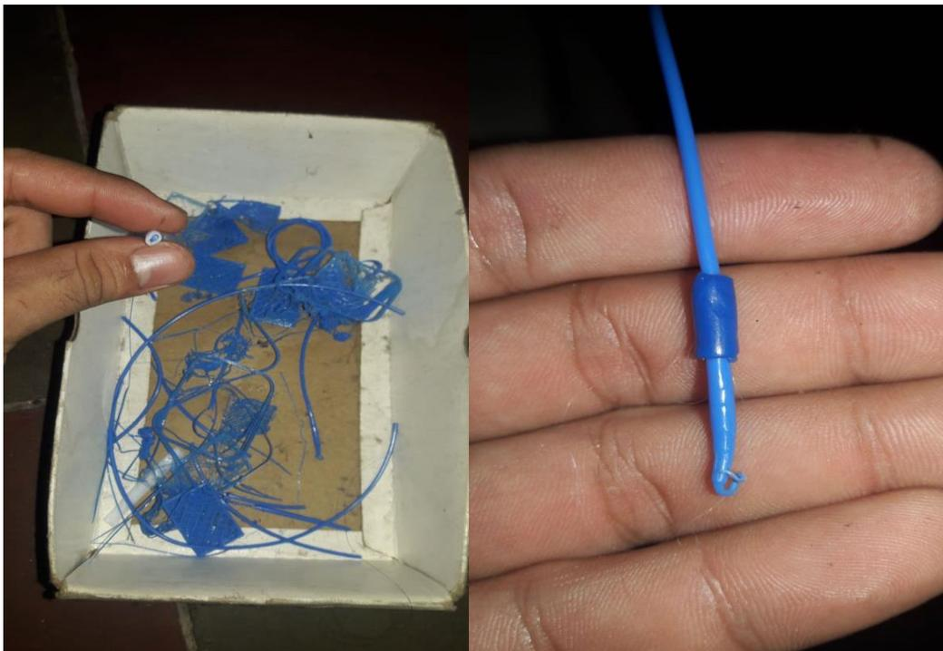
**Figura 5.26:** errores de impresión por descalibración y atascos de material.
