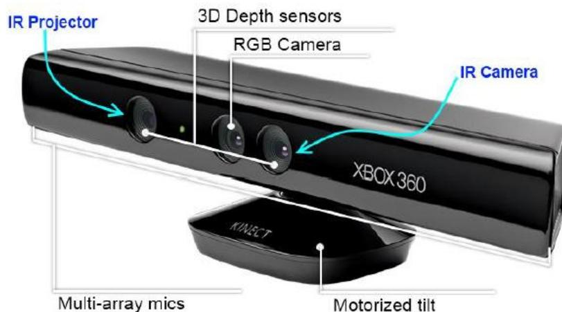
**Figura 1.9:** Detallado de sensor Kinect de Microsoft (15).
