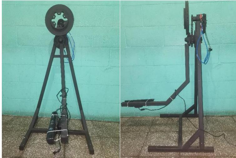
**Figura 3.8:** Máquina de brazo giratorio para escaneo
