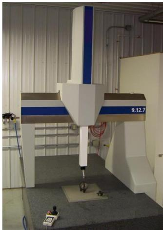
**Figura 1.3:** Escáner de contacto CMM (1).
