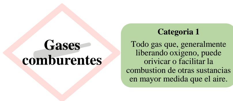
Figura B.4 categorías y criterios de clasificación para gases comburentes. Fuente: (Naciones Unidas, 2017)
