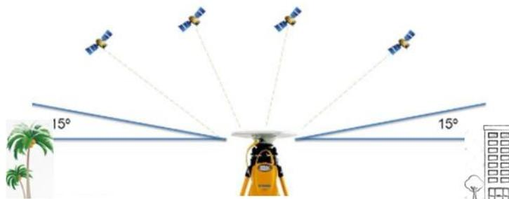
**Imágen 3.5: Esquema de la Máscara en una Observación.**
