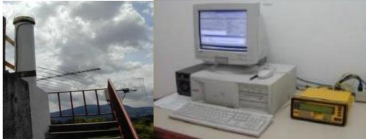
Imágen 5.7: Antena Trimble Choke Ring
