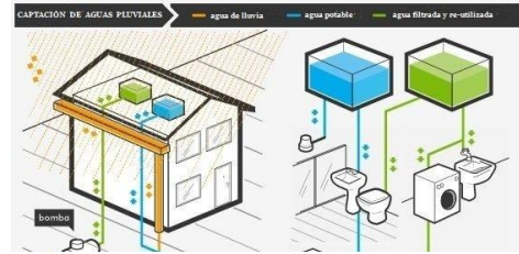
Ilustración 5: Sistema de captación de aguas lluvias.
