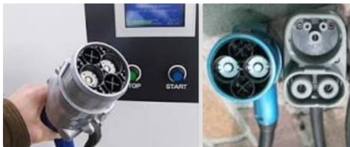
Figura 126: Conector CHAdeMO para EVs.
