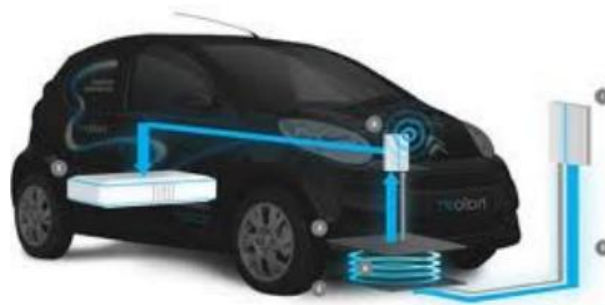
Figura 127: Modo de carga rápida por inductivo para EV's.
