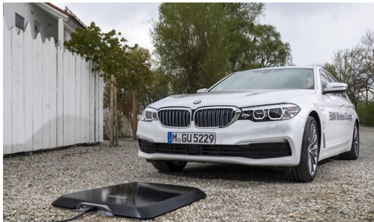
Figura 130: BMW Wireless Charging con carga lenta por inducción.
