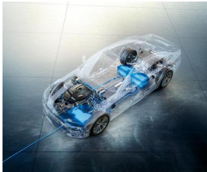
Figura 131: Vista interna de un BMW Wireless Charging por medio de inducción lenta
