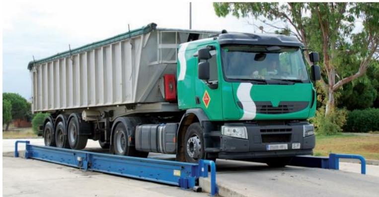
Ilustración 62 Pesaje de camión
