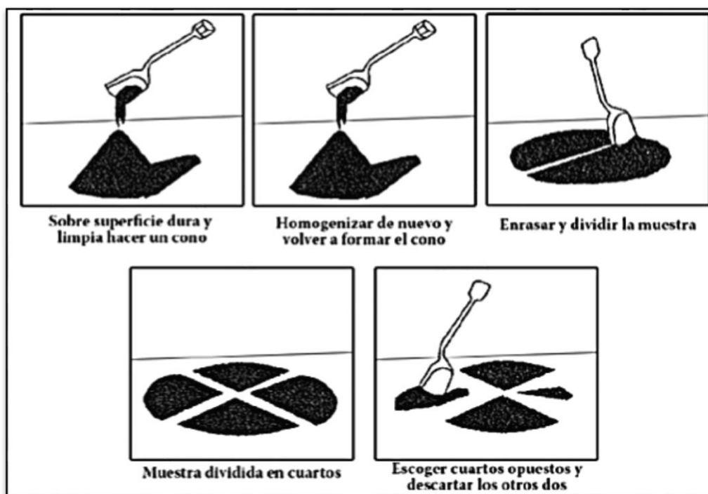
Figura 3.4 Método de cuarteo “B” según ASTM C 702
