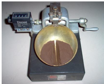
Figura 3.15 Ranurador de suelo en copa de Casa Grande
