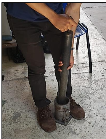
Figura 3.19 Compactación de las capas de suelo.
