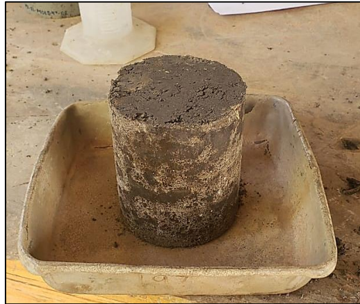
Figura 3.20 Desmante de suelo compactado.
