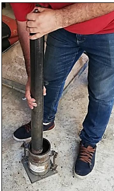
Figura 3.23 Compactación de las capas para CBR con la humedad optima
