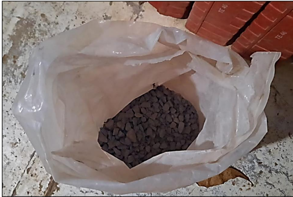
Figura 3.28 Grava N° 2 para ensayar
