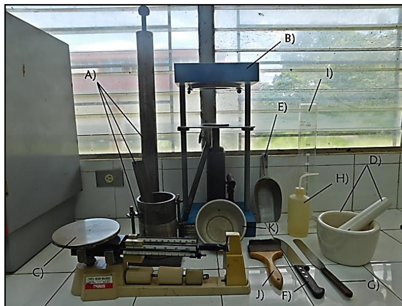
Figura 3.17 Equipo: A) Martillo apisonador con su collarín y base B) Gato Hidráulico C) Balanza D) Mortero y Pistilo E) Cucharon F) Cuchillo G) Espátula H) Piseta I) Probeta J) Brocha K) Taras para el contenido de Humedad.
