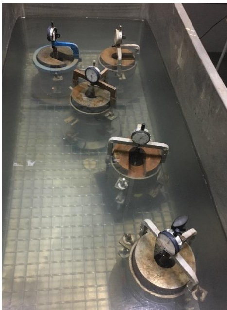
Figura 3.24 Proceso de inmersión CBR
