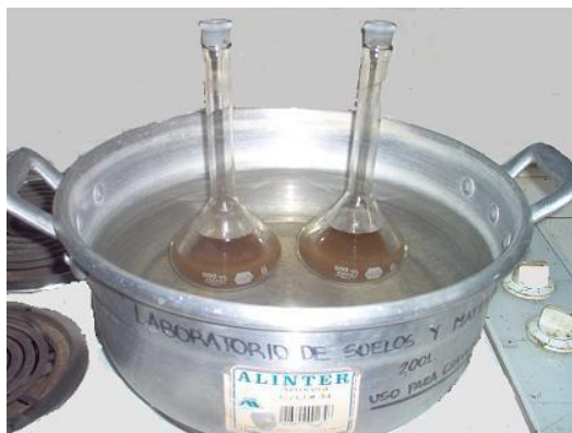
Figura 3.7. Desairado de la lechada por el método de ebullición.
