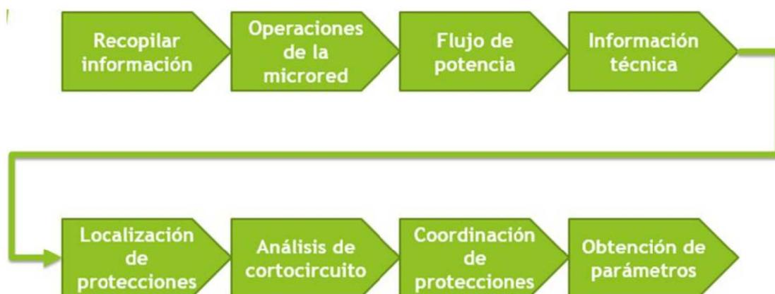
Figura 4-7 Esquema para la configuración de protecciones de sobre corriente
