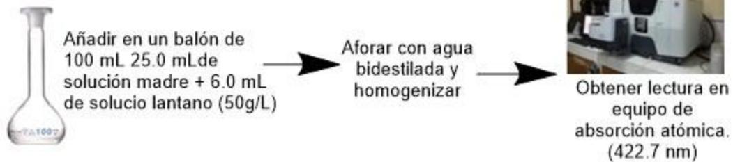
Figura N°35 Procedimiento para determinación de Calcio
