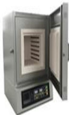
Colocar el crisol limpio e identificado en una mufla a 550 °C durante 1 hora
