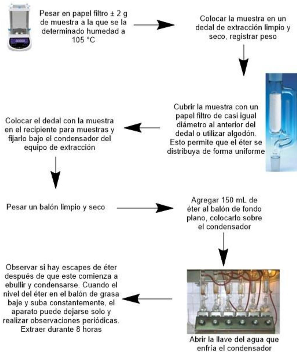
Figura N°30 Procedimiento para la determinación de extracto etéreo.
