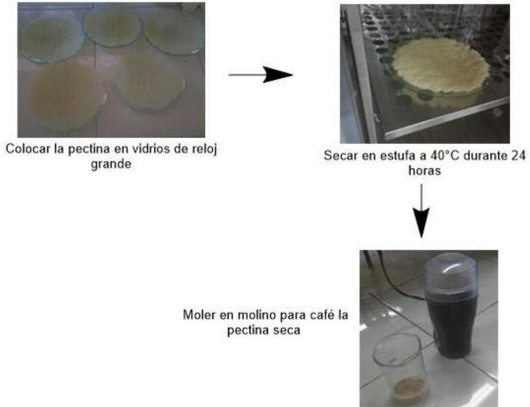
**Figura N°19** Continuación procedimiento de extracción de pectina de naranja (hidrólisis ácida)
