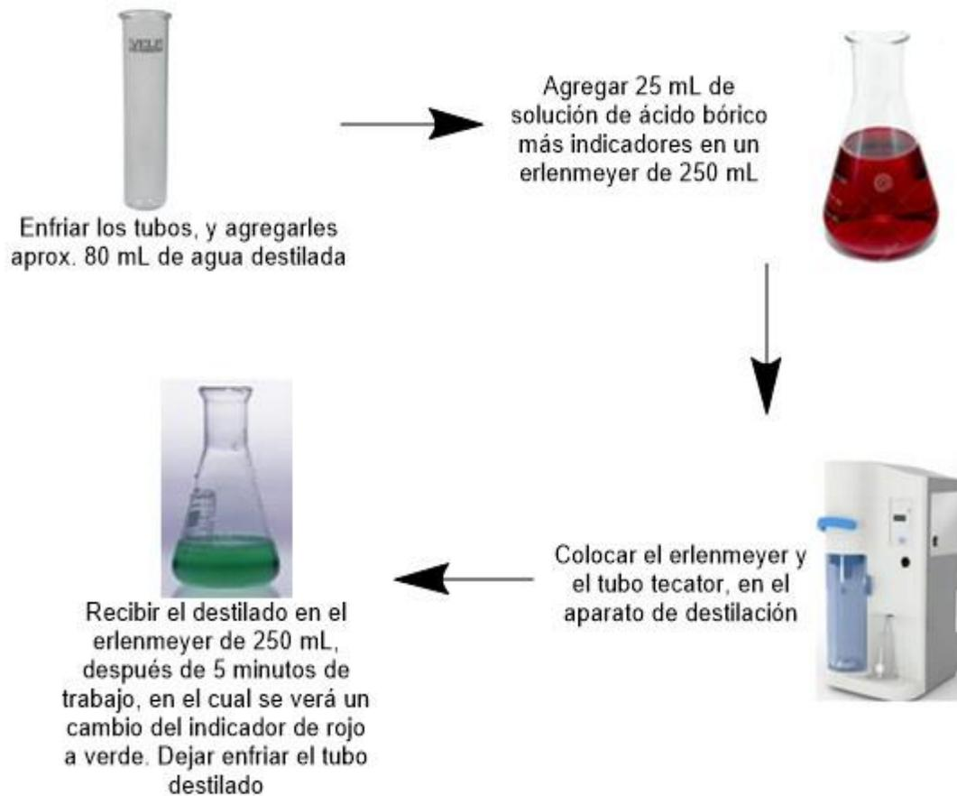
**Figura N°28** Procedimiento para la determinación de nitrógeno proteico, etapa de Destilación.
