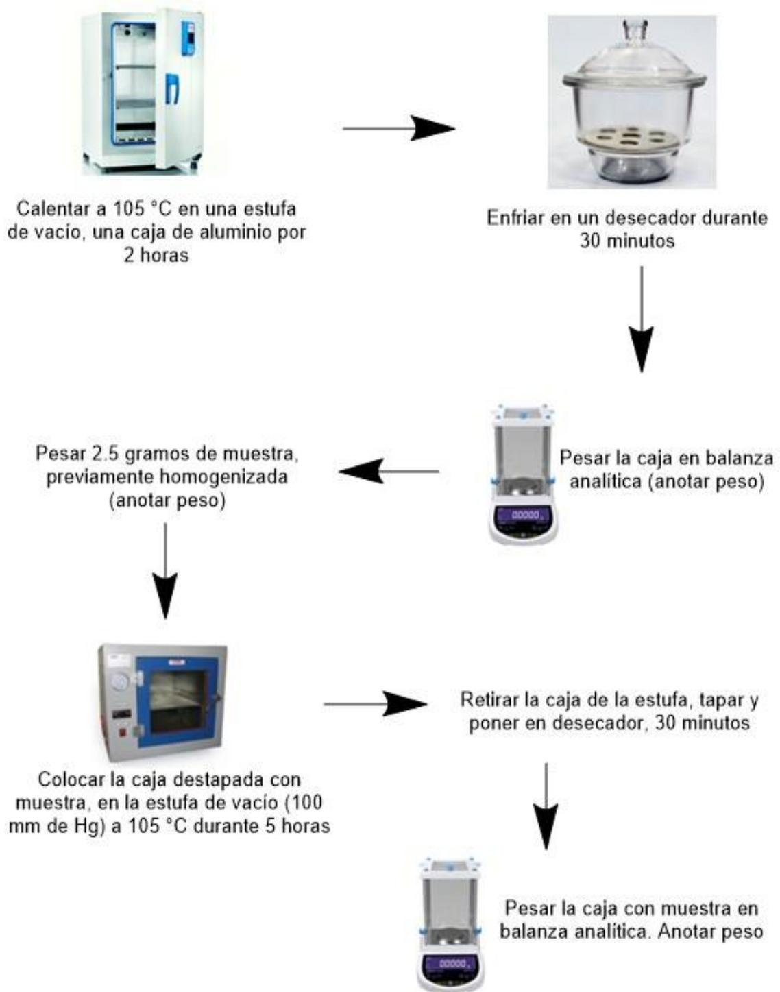
**Figura N°25** Procedimiento para la determinación de humedad total
