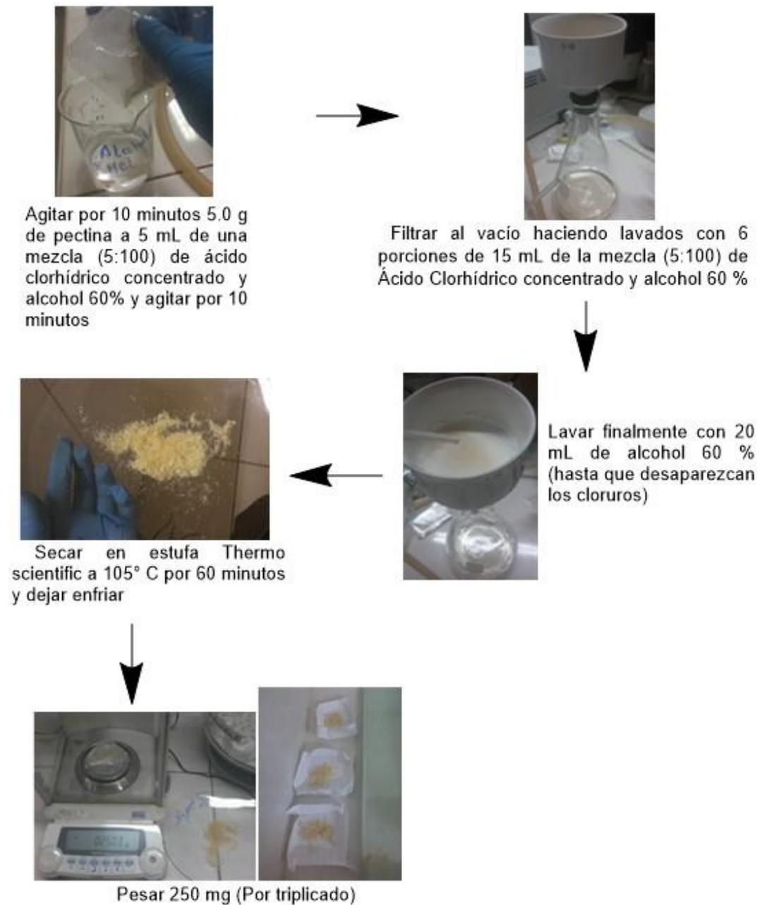
**Figura N° 22** Procedimiento para la determinación de grupos metoxilos y ácido Galacturónico
