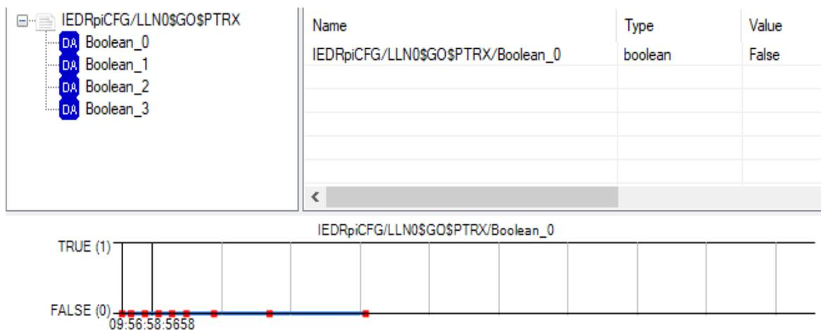
*Figura 123. Mensaje GOOSE enviado por las protecciones del transformador*
