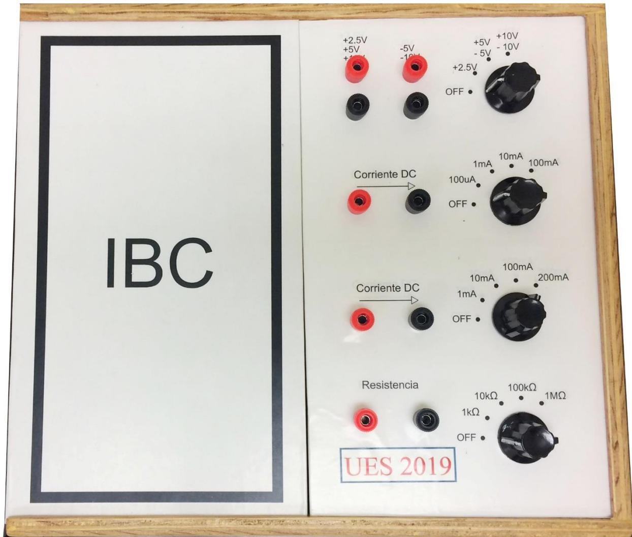
*Figura 6. Fuente de precisión o calibrador.*
