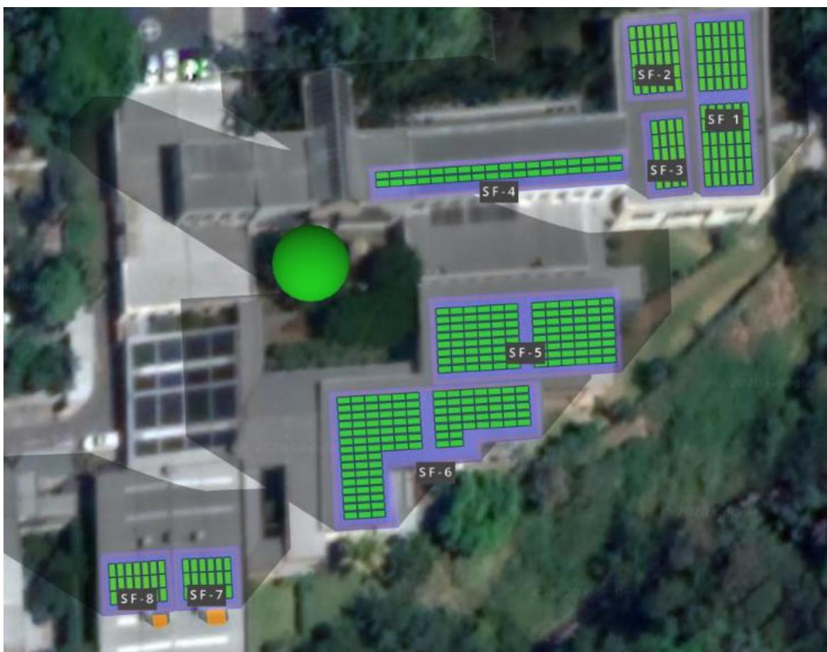
Figura 76 *distribución de paneles fotovoltaicos con potencia de 125 kWp sobre cubierta de techos de FUNTER (Elaboración propia con HelioScope).*
