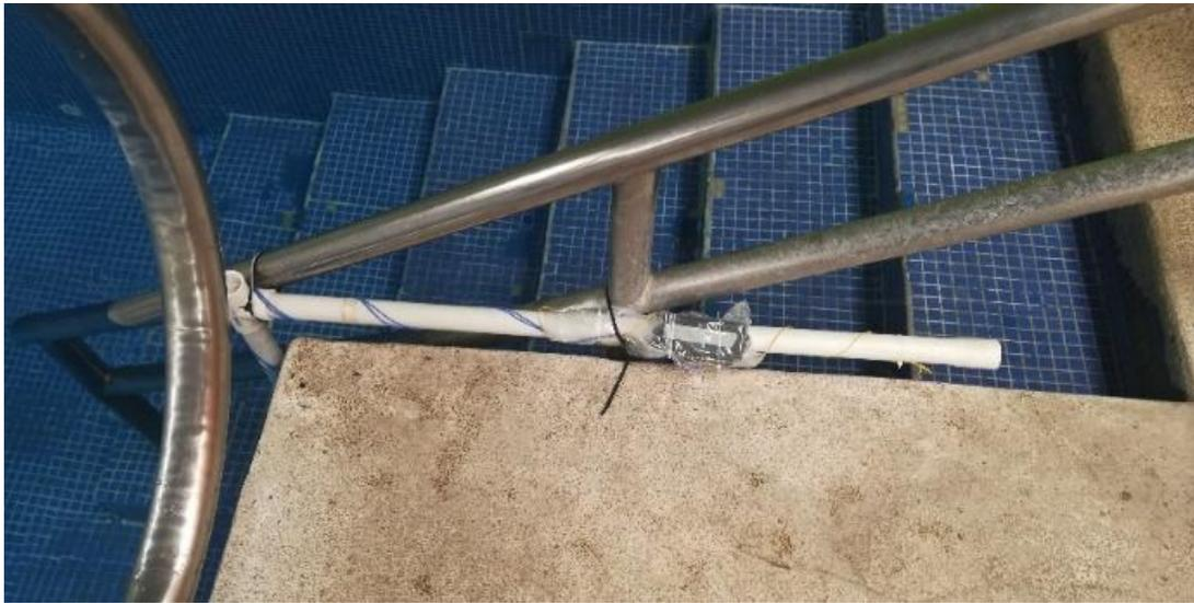
Figura 61 Arreglo de sistema de sensores de temperatura instalados en pasamano de piscina.
