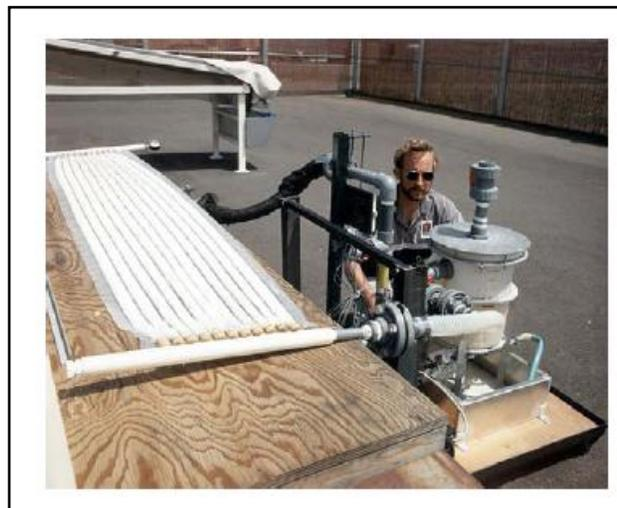
Figura 2. 22 Instalación de un colector tubular.
