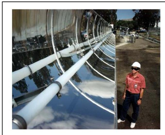
**Figura 2. 13 Colector cilindro-parabólico adaptado para fotocatalisis solar**
