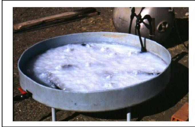
**Figura 2. 23** Instalación experimental de un colector tipo balsa superficial en la Plataforma Solar de Almería.
