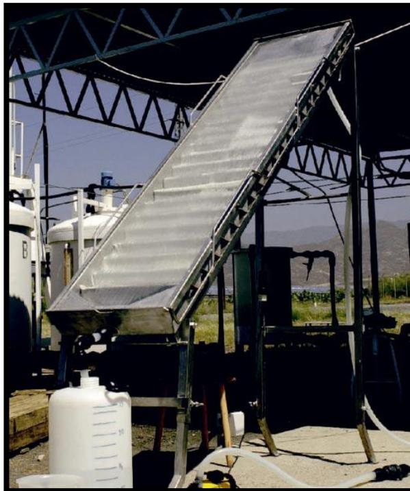
**Figura 2. 26 Fotoreactor “en cascada” utilizado para ensayar titania depositada sobre un soporte de fibra preparada por la empresa AHLSTROM PAPER**
