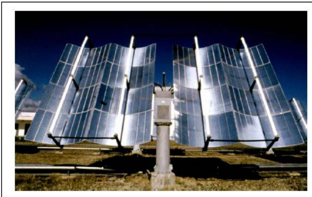
Figura 2. 18 Colector cilindro-parabólico con seguimiento en dos ejes instalado en la Plataforma Solar de Almería.
