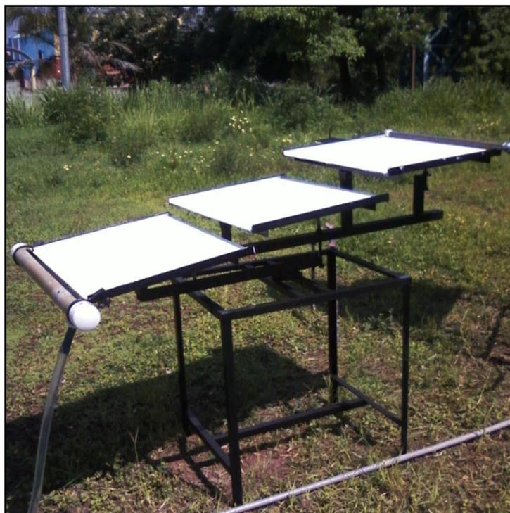
Figura 3. 3 Estructura rotatoria del reactor de placas en el área de tratamiento
