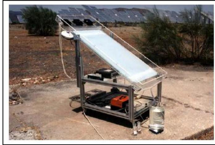
Figura 2. 19 Instalación experimental de un colector de placa plana utilizado por el ISFH (Institut für Solarenergieforschung GmbH, Hannover, Alemania) en las instalaciones de la PSA.
