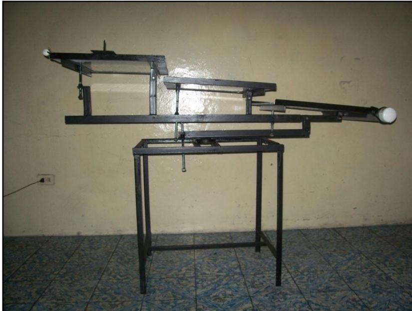
Figura 3. 1 Estructura rotatoria del reactor de placas, vista lateral.
