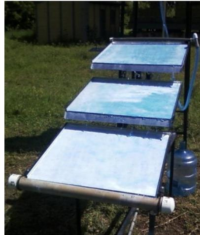
**Figura 3. 6** Vista de placas con  $\text{TiO}_2$  inmovilizado al 40% de envenenamiento
