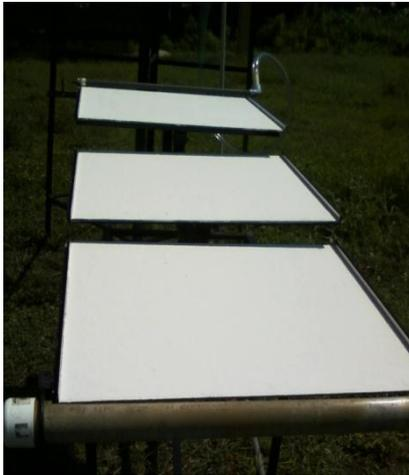
**Figura 3. 5** Vista de placas con  $\text{TiO}_2$  inmovilizado al 0% de envenenamiento
