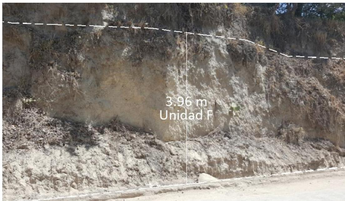
Figura No. 4.21 Talud de punto Lago de Ilopango Punto 1 en la zona proximal al foco de emisión.
