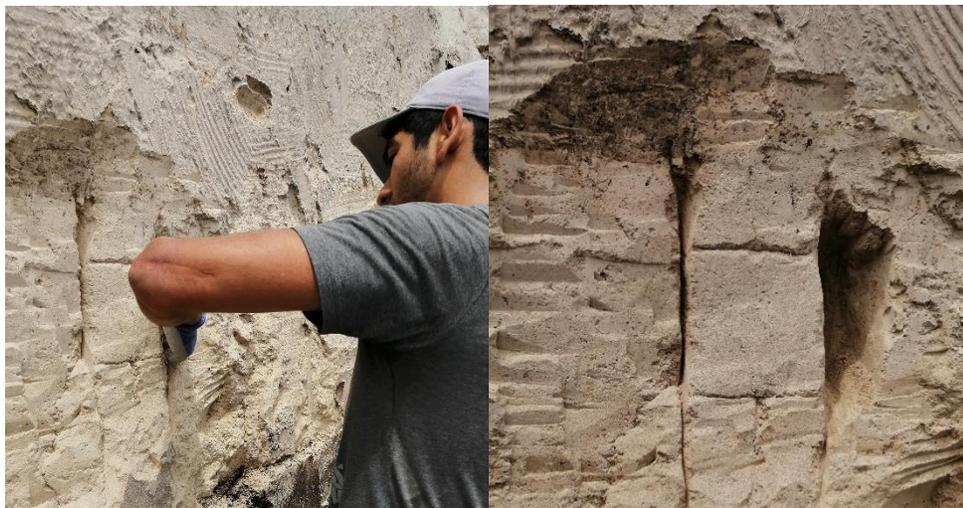
*Figura No 3.9a: Excavación de zanja para toma de muestra inalterada.
