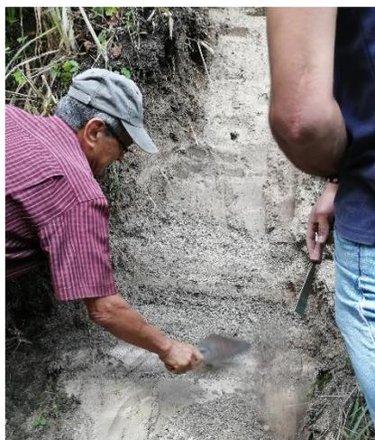
*Figura No 3.8: Alisado de superficie para toma de muestra inalterada.
