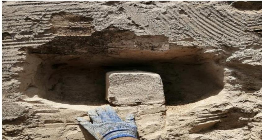
*Figura No 3.10: Extracción de muestra inalterada, Perfilado de caras de espécimen, Muestra perfilada.*
