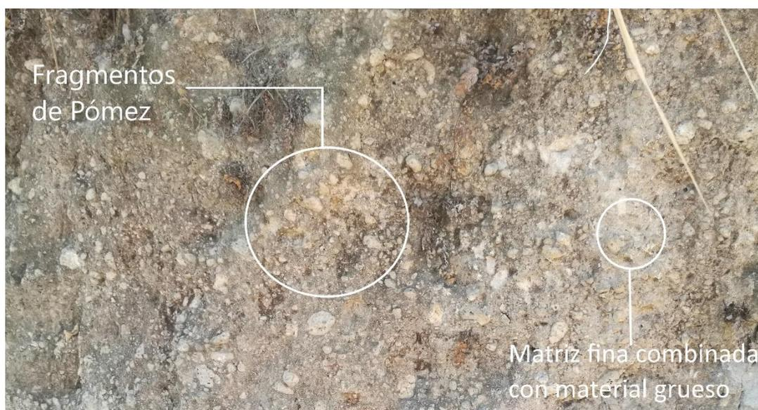
Figura No. 4.5 Representación del material que conforma el talud de Apopa Punto 2 en la zona distal al foco de emisión.
