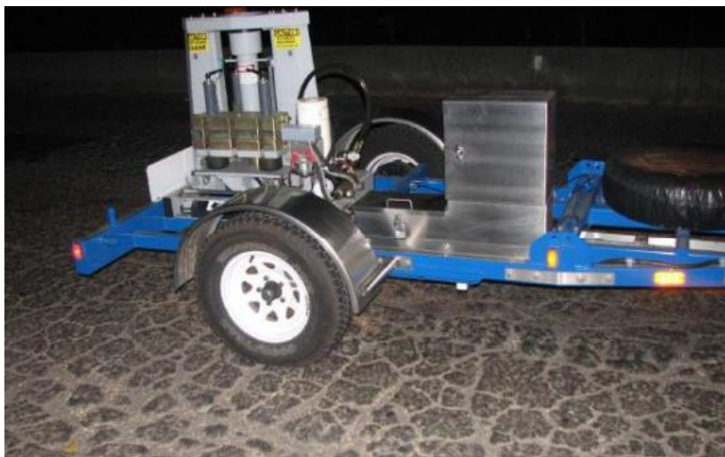
Figura 3.31 Zona donde no se pudo asentar el plato de carga del equipo Deflectómetro de Impacto en el sentido Puerto Acajutla - Sonsonate.
