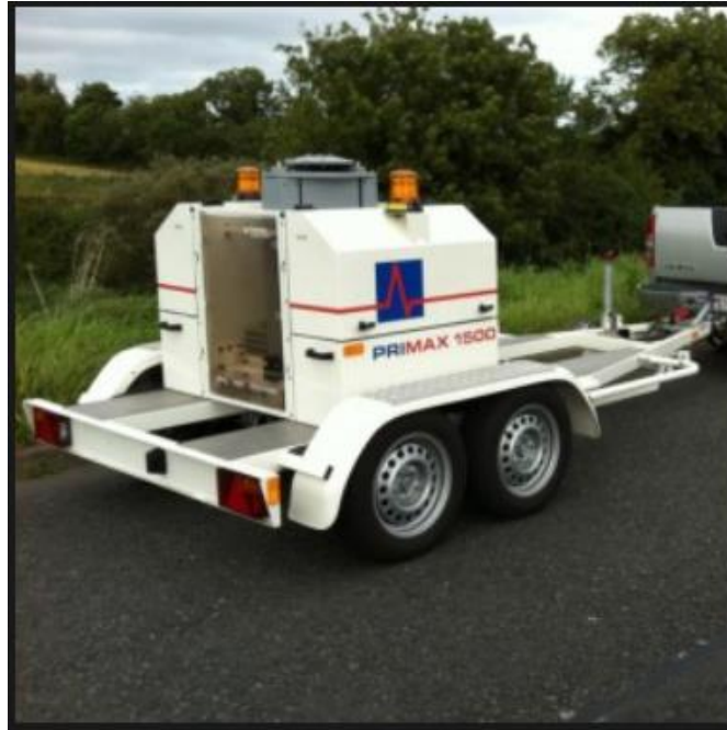
Figura 2.8 FWD con remolque.
