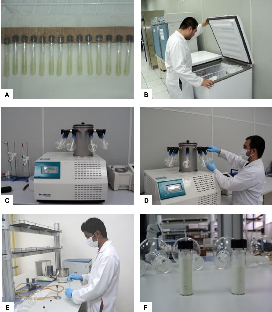
Figura N° 50. Liofilización del látex de las papayas: A. Látex recolectado en los tubos; B. Refrigerador donde se congelo el látex; C. Liofilizador Telstar Cryodos 6 con los tubos con látex; D. Retiro de los tubos al final de la liofilización; E. Recolección de la enzima liofilizada de los tubos; F. Viales con la enzima papaína liofilizada.
