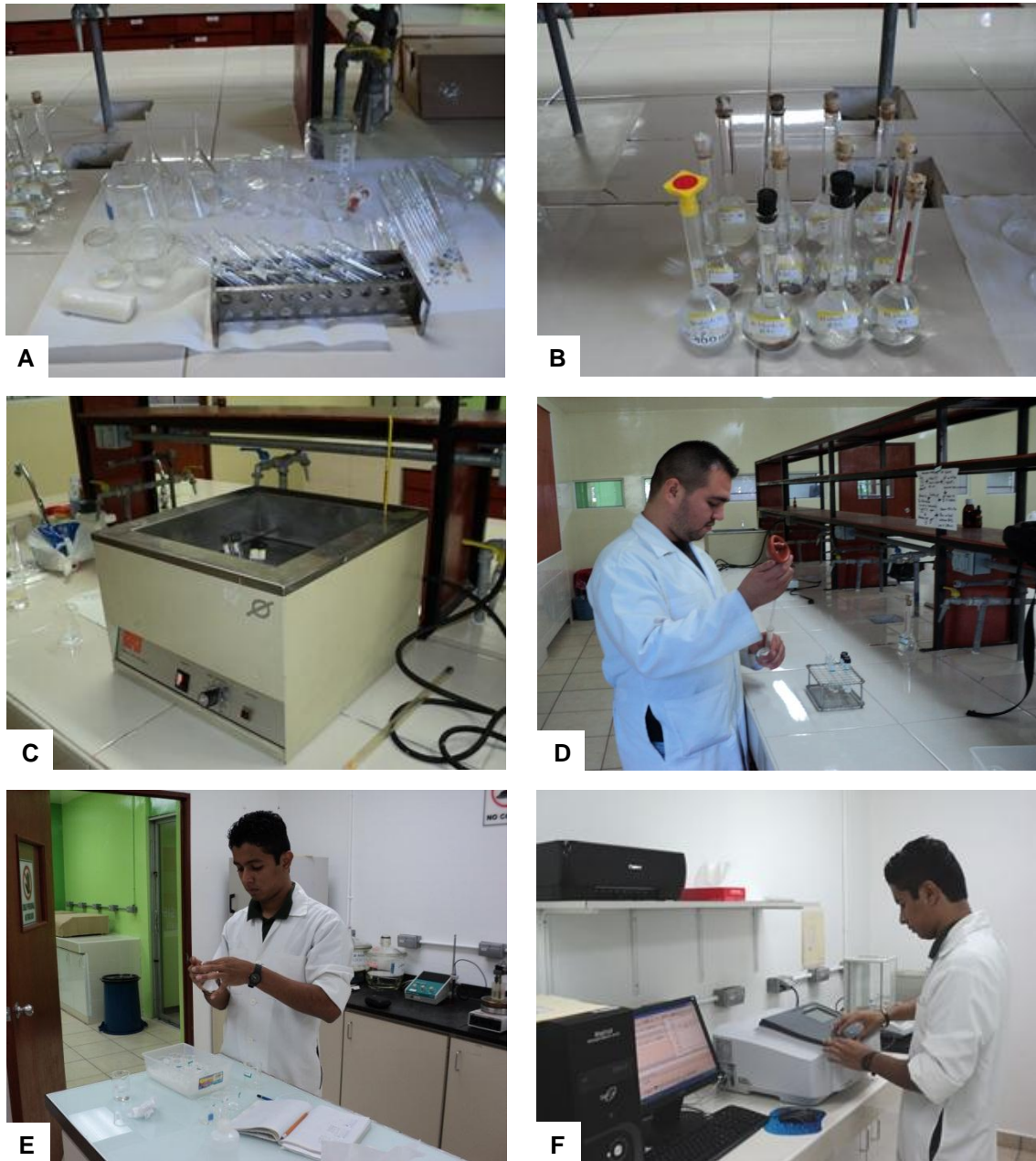
Figura Nº 52. Determinación de la actividad proteolítica por el método modificado de Kunitz: A. Cristalería utilizada; B. Soluciones preparadas para la determinación; C. Baño de agua donde se incubaron los tubos; D. Preparación de los tubos E^0 , E^{0'} y E^{15} ; E y F. Determinación de la absorbancia de los filtrados de E^{15} y E^{0'} .
