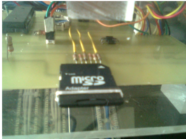
Figura 3.2. Ranura que muestra la ubicación de la memoria SD a ser removida.
