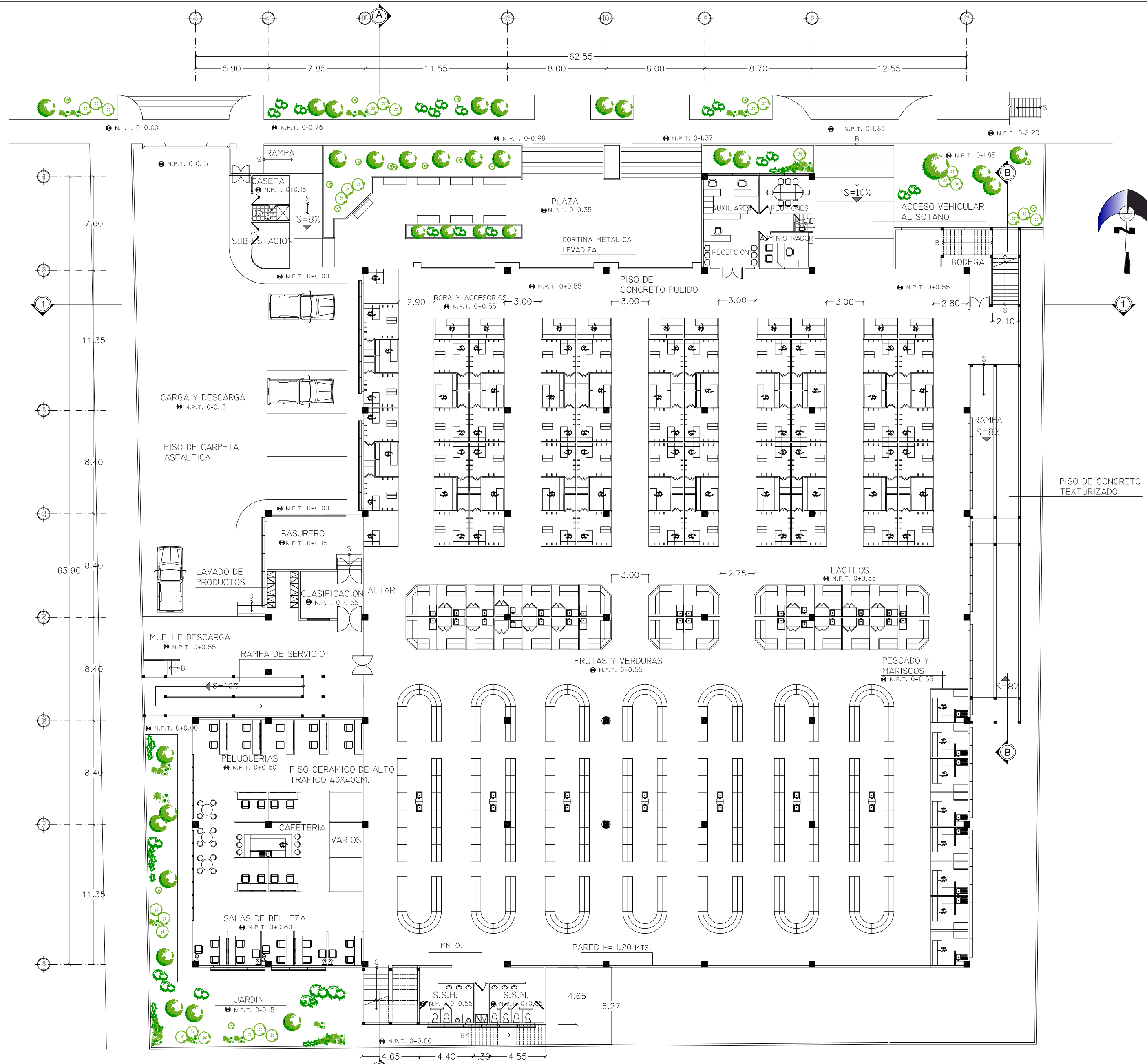
PLANTA ARQUITECTONICA PRIMER NIVEL Esc. 1:250
