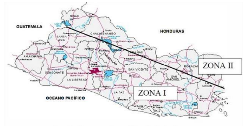
Imagen 12 Zonificación sísmica para la Republica de El Salvador, Sep. 1993 Fuente: Norma Técnica para Diseño por sismo
