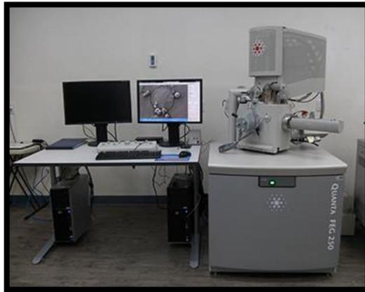
Figura N° 5. Microscopio Electrónico de Barrido.
