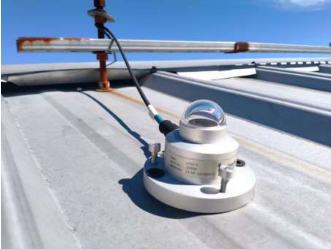
Figura 6-4 Piranómetro con constante de calibración: 19.07 \text{ uVm}^2/\text{W} .
