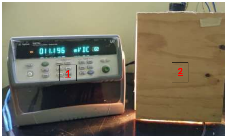
Figura 2-18 Pruebas de laboratorio. 1. DataLogger encargado de leer el voltaje del piranometro. 2. Camara de Prueba cerrada.
