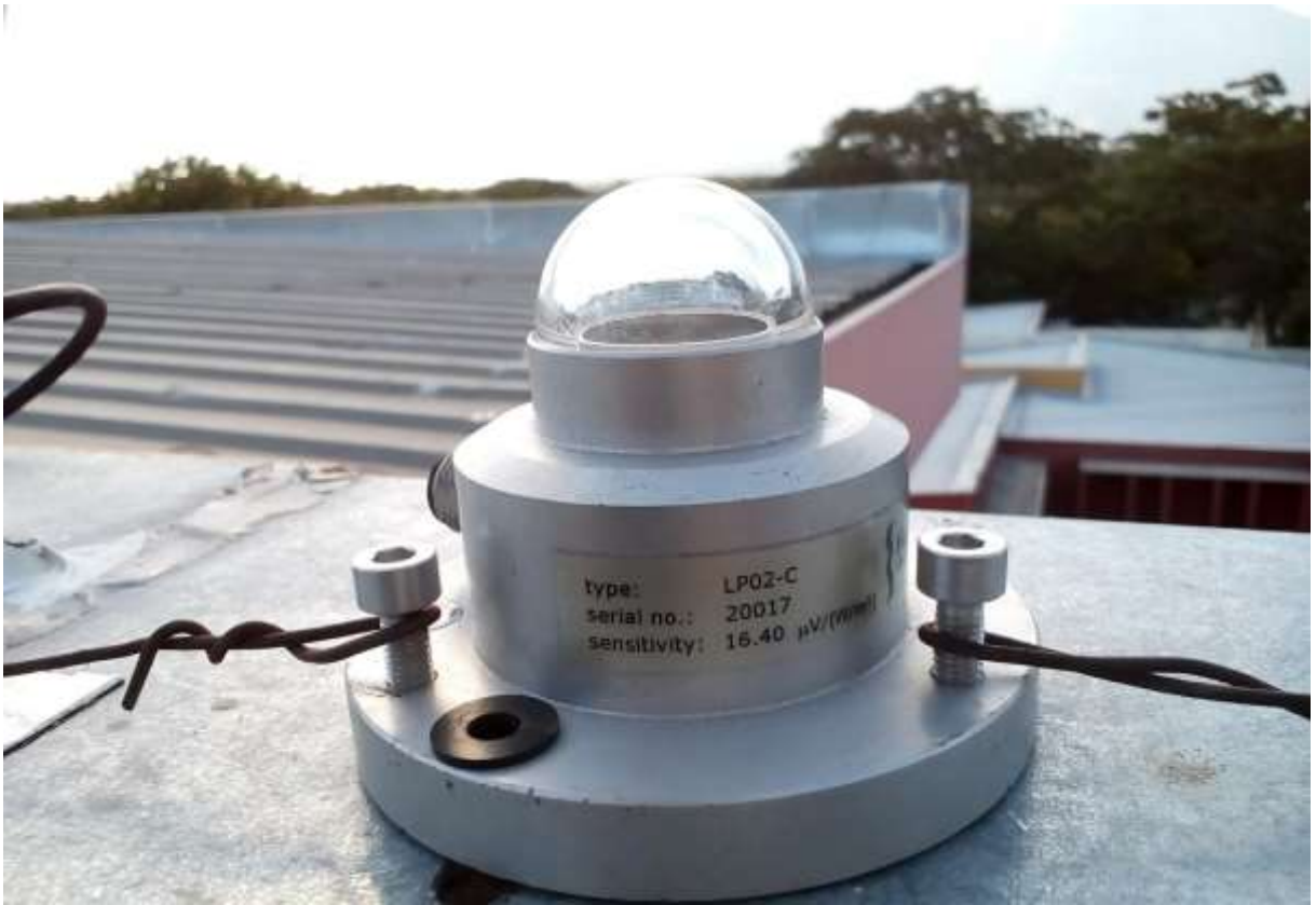
Figura 6-15 Piranómetro con constante de calibración: 16.40 \mu\text{V m}^2/\text{W} .
