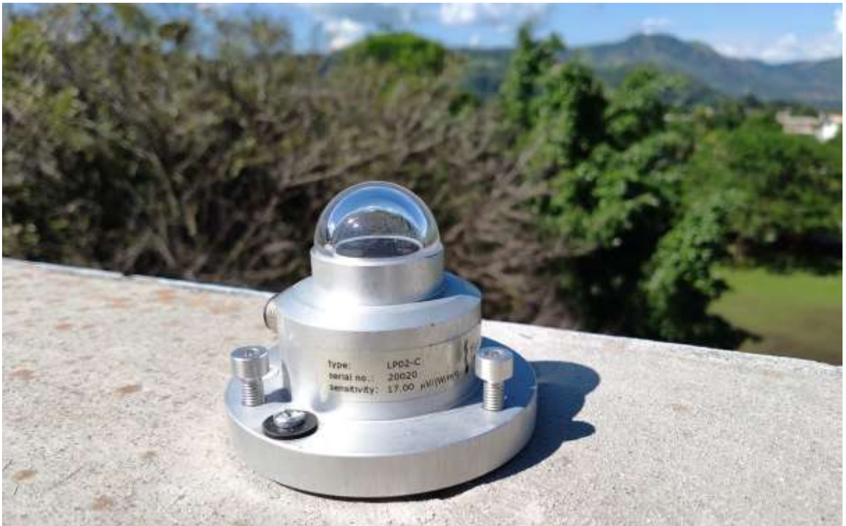
Figura 6-9 Piranómetro con constante de calibración: 17.00 \mu\text{V}/\text{W} .
