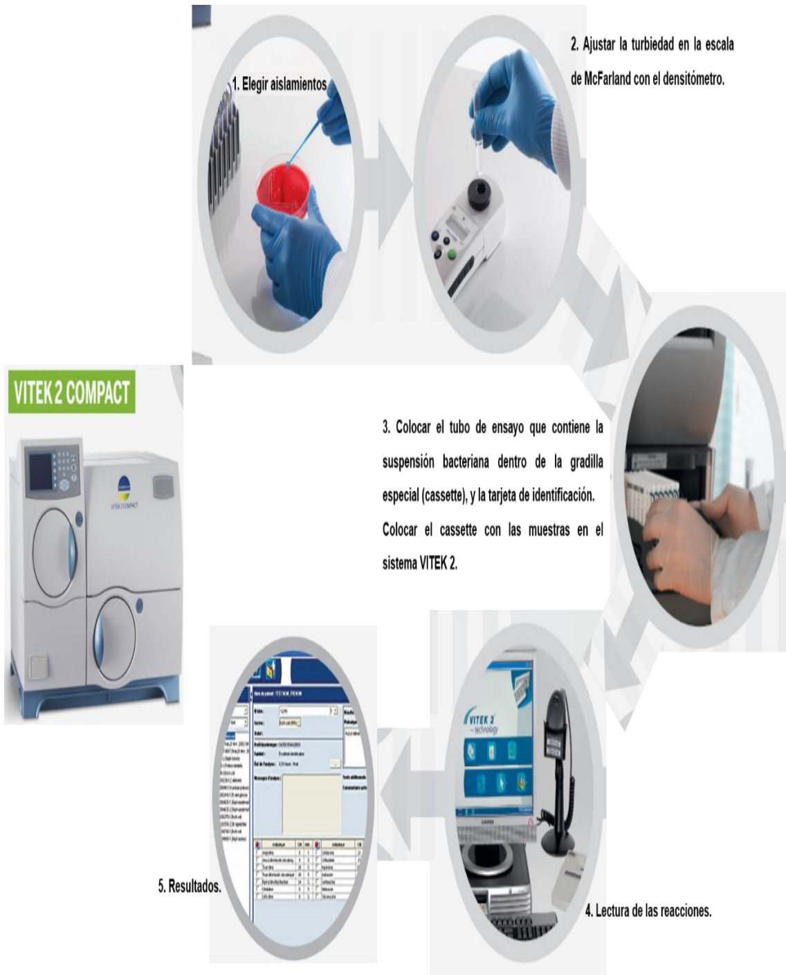
Figura N°39 Esquema para la determinación de la sensibilidad usando el equipo VITEK 2 Compact
