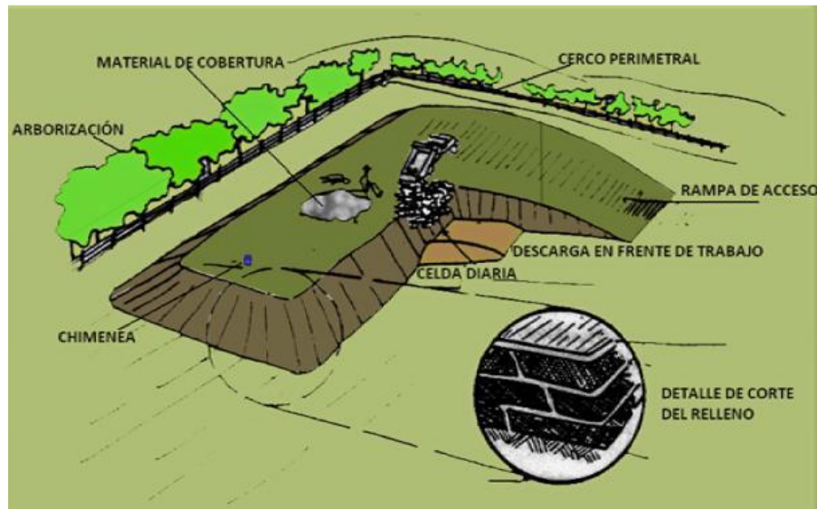
Figura 15. Relleno sanitario manual.
