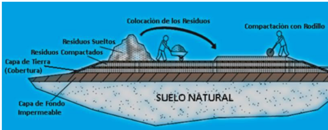
Figura 20. Método de área aplicado a un relleno sanitario manual.
