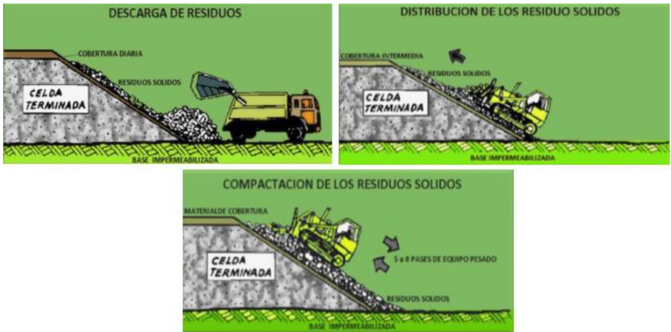
Figura 16. Procesos de un relleno sanitario mecanizado.
