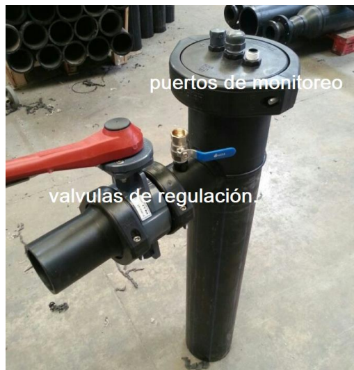
Figura 24. Cabezal de pozo de extracción.
