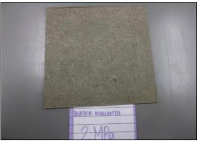
Figura 3.4 El bio-tablero de jacinto de agua (E. crassipes) producido con éxito.
