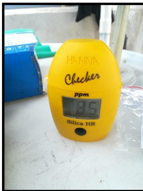
Figura 2.14. Colorímetro HI770 Checker ® HC para determinación de sílice en aguas domesticas e industriales.
