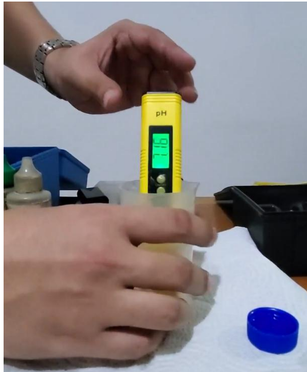
Figura C.6. Determinación de pH en muestra de agua suavizada con pH-metro portátil VIVOSUN.
