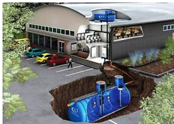
Figura 1.18. Instalación Industrial de un Sistema de Captación de Agua Lluvia.
