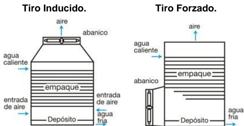
Figura 1.7. Clasificación de torres de tiro mecánico. Fuente: (Lange et al., 2010).
