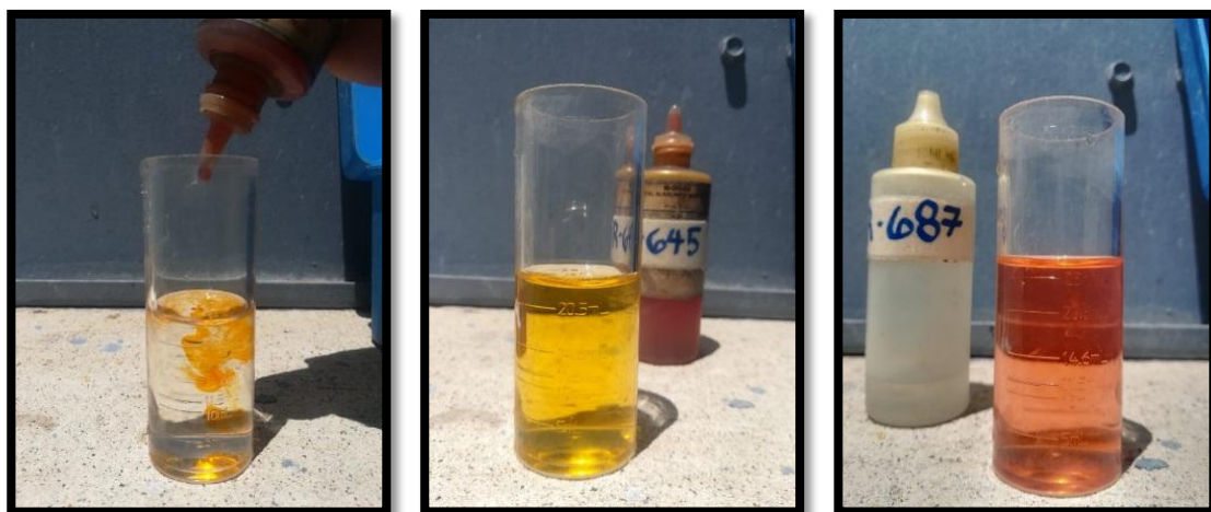
Figura 2.16. Análisis de alcalinidad total mediante método con naranja de metilo.
