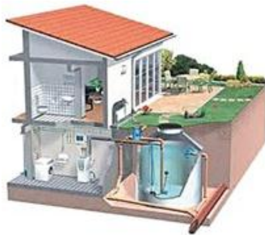
Figura 1.17. Instalación Residencial de un Sistema de Captación de Agua Lluvia.
