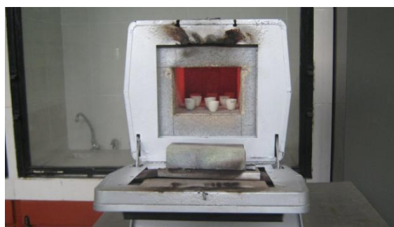
Figura N°11. Calcinación de Oxalato de Calcio
