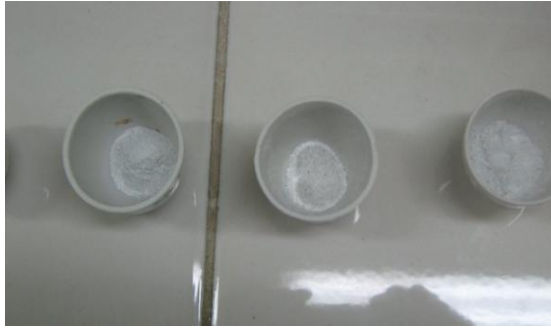
Figura N°13. Obtención de Oxido de calcio en crisoles tarados
