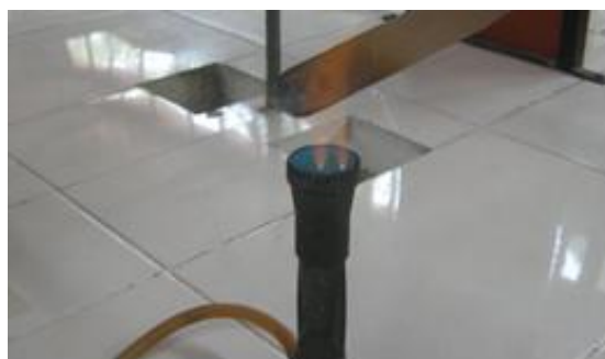
Figura N°12. Comprobación obtención de CaO: llama roja-anaranjada
