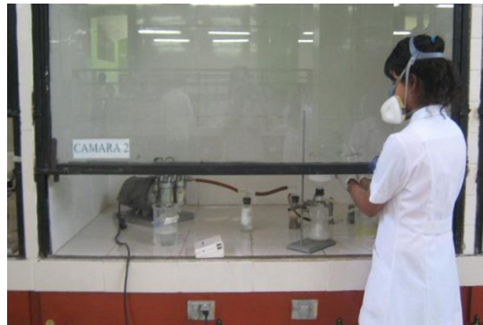
Figura N°9. Obtención de Oxalato de calcio en equipo de filtración al vacío.
