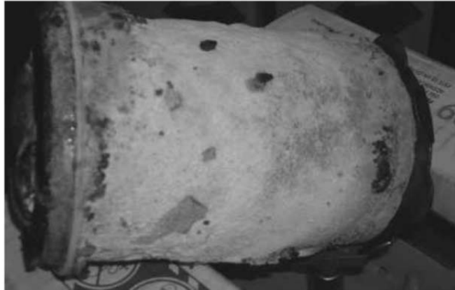
Figura 2.3 Piedra de filtro saturada de humedad y corrosión del sistema.
