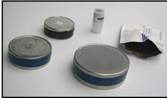
Figura 2.28: Cánister de carbón activado. Extraído de «RadonSpecialist». Recuperado de https://radonspecialist.org .
