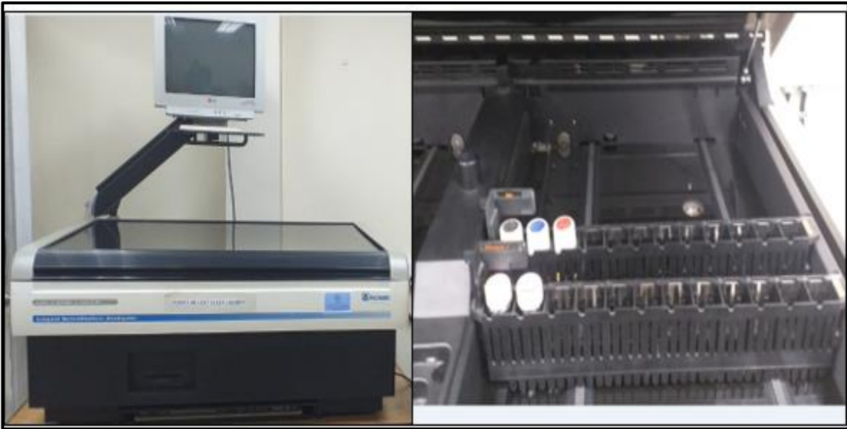
Figura 5.3: Equipo de centelleo líquido CIAN-FIA-UES (izquierda). Porta casete y viales a medir dentro del equipo (derecha).
