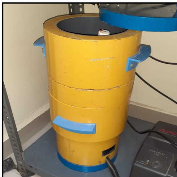
Figura 4.42: Blindaje de plomo que recubre el sistema.
