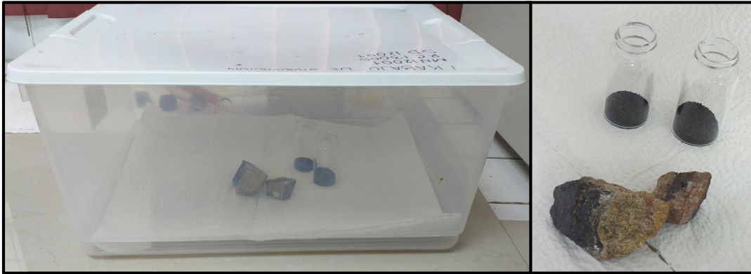
Figura 5.1: Cámara que contiene viales con carbón activado y rocas uranílicas (izquierda). Exposición de 2 g de carbón activado a rocas que liberan gas radón al interior de la cámara (derecha).
