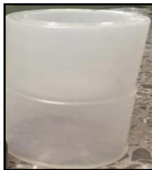
Figura 3.6: Recipiente impermeable al radón. Fuente: (Noverques Medina, 2017).
