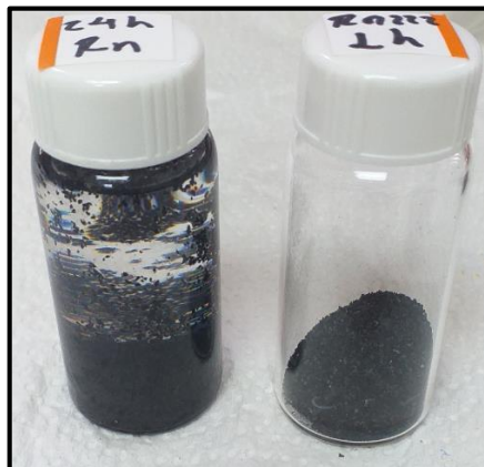
Figura 5.2: Vial con carbón activado (derecha). Vial con carbón activado y coctel de centelleo a base de tolueno (izquierda).
