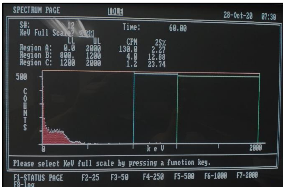
Figura 5.5: Espectro que muestra la actividad registrada de CPM provenientes de radón y descendientes absorbidos en carbón activado.
