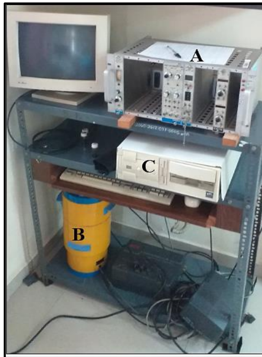
Figura 5.6. Módulos que componen espectrometría gamma de CIAN-FIA. Módulo A: generador de alta tensión. Módulo B: castillo de plomo como blindaje para que emisiones gamma exteriores no contribuyan en el conteo de la muestra que se coloca al interior. Módulo C: computador y monitor donde se configura, calibra y registra la información brindada por el equipo.
