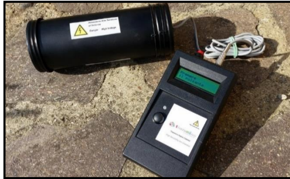
Figura 2.24: Cámara de iones con software en un microcontrolador PIC. Extraído de «THEREMINO». Recuperado de https://www.theremino.com .
