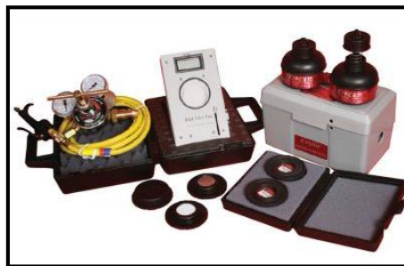
Figura 2.29: Electets E-perm S. Extraído de «Radon Supplies». Recuperado de https://www.radonsupplies.com .
