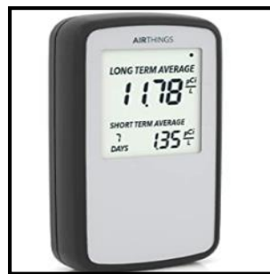
Figura 2.25: Monitor electrostático de difusión pasiva Corentium Home Radon Detector. Extraído de «Productos Airthings». Recuperado de https://cdn2.hubspot.net .
