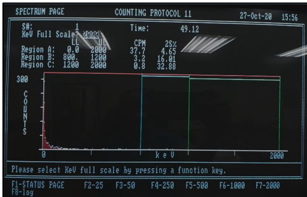
Figura 5.4: Espectro de vial blanco en equipo de centelleo líquido.
