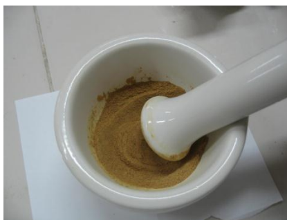
Fig. N°22 Pulverización de la goma-resina de Eucalyptus citriodora .
