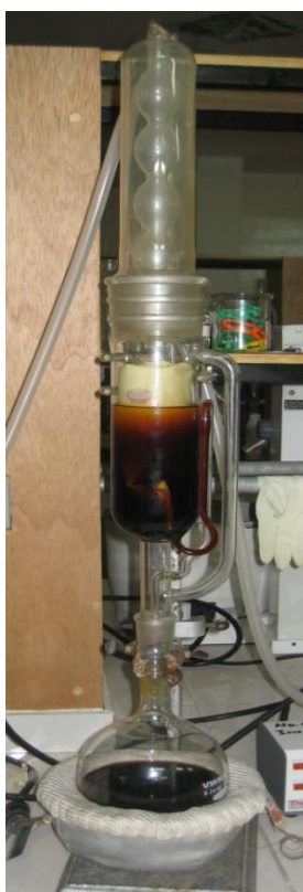
Fig. N°23 Extracción alcohólica de la goma resina de Eucalyptus citriodora .
