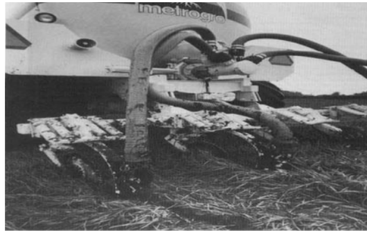
Figura 4.15: Equipo de inyección de biosólidos.
