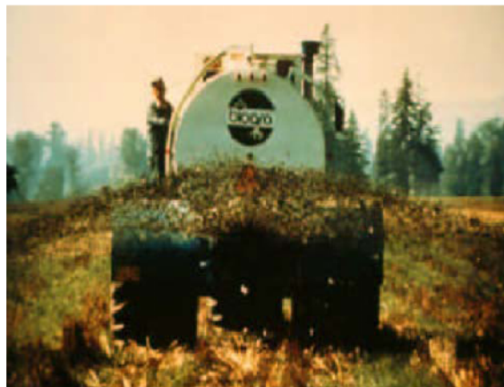
Figura 4.16: Vehículo especializado para la aplicación de biosólidos.
