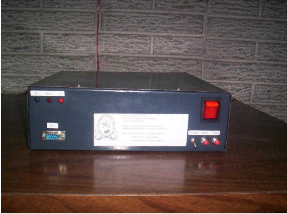
Figura A.1.1 Cara frontal del medidor trifásico multifunción
