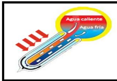
Figura 3. 12 Funcionamiento de un tubo al vacío.
