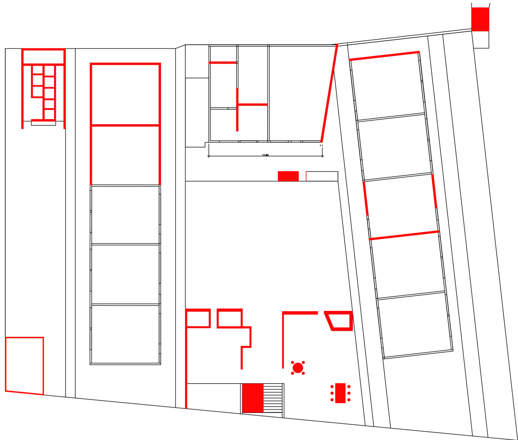
FIGURA N1: PLANO DE DEMOLICIONES.
