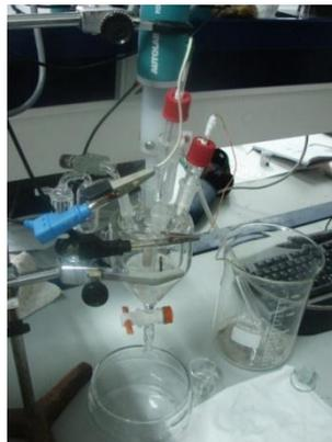
Fig.Nº.35 Celda experimental de tres electrodos.
