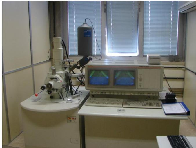
Fig. N° 93 Detector EDX acoplado a microscopio electrónico de barrido JeolJem modelo 1010 con un detector de silicio, con ventana de Be. 20 KeV.
