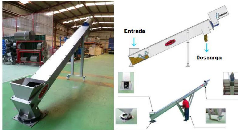
Figura 4.19 Transportador de tornillo. Fuente: (Bega, 2020).
