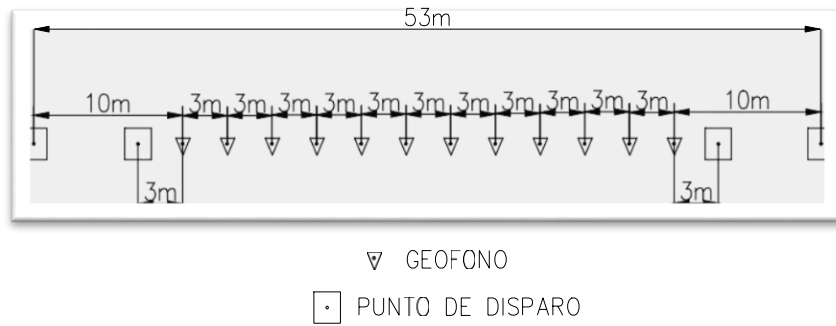
ILUSTRACIÓN 3.26: Configuración utilizada en los ensayos de refracción sísmica.
