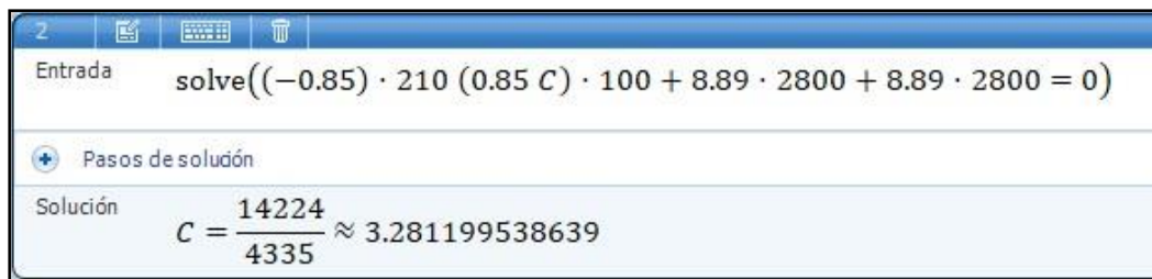
ILUSTRACIÓN 5.64: Cálculo de valor "C" con Microsoft Mathematics condición de resistencia I – Zapata de estribo.
