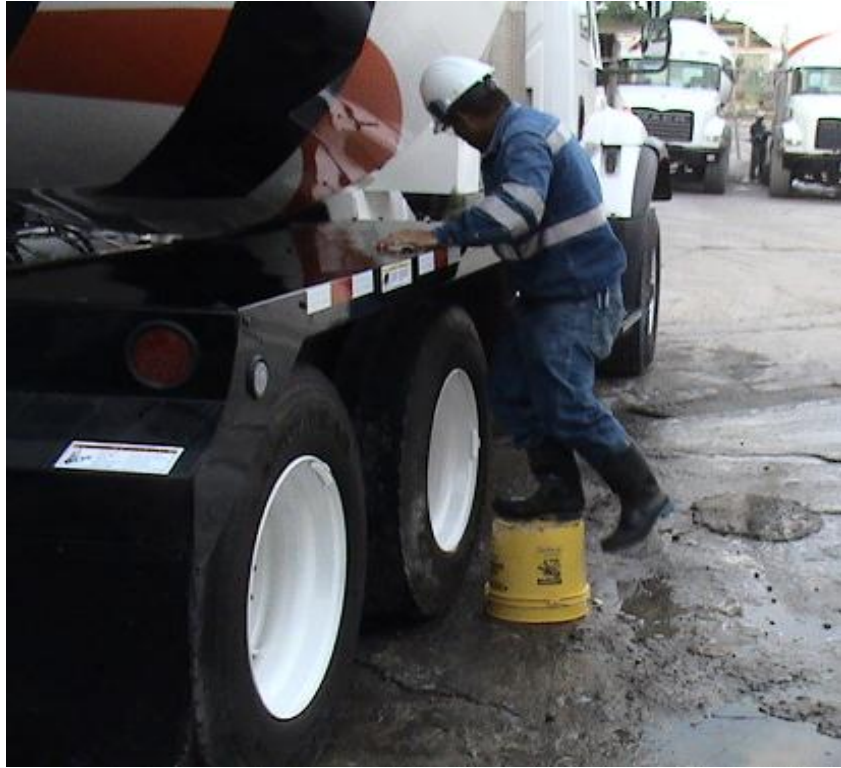
Figura N°34 Limpieza final de equipo para operador de mixer
