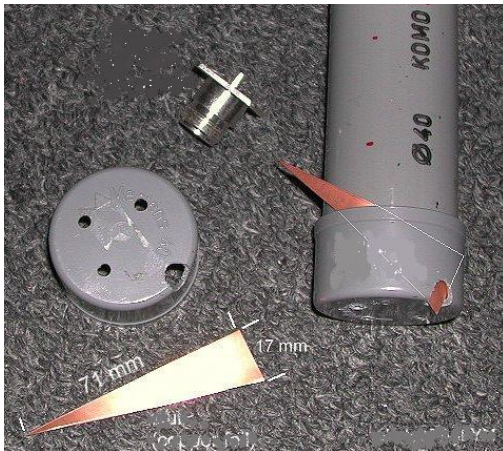
Figura B.4 instalación del acoplador de impedancias.
