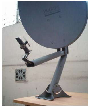
Figura 4.2 Antena parabólica con elemento radiante para 2.4 Ghz.
