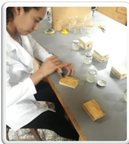
Figura 11. Aplicación de resina de recubrimiento sobre superficies de madera.
