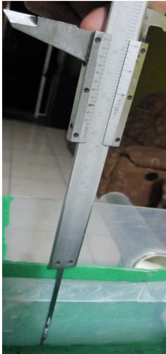
Figura 5.32. Altura de vertedero de la caja de salida del sistema de detención de aguas lluvias a escala 1:20 [Fuente: Elaboración propia].
