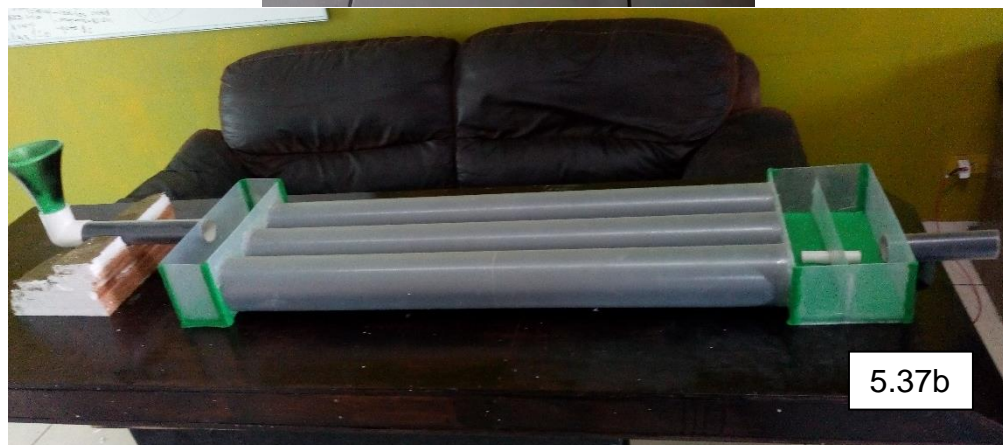
Figura 5.37a y 5.37b Se puede observar el sistema de detención de aguas lluvias a escala 1:20 ya construido [Fuente: Elaboración propia].
