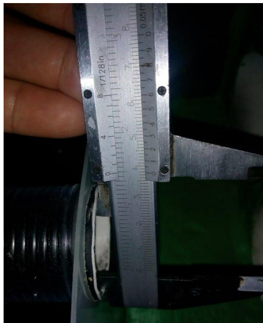
Figura 5.22. Dimensión de Tubería colectora de entrada al sistema de detención de aguas lluvias a escala 1:20 diámetro de 1 ½" [Fuente: Elaboración propia].
