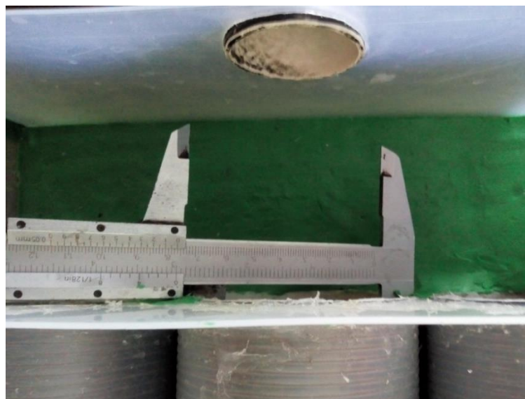
Figura 5.26 Dimensión de la tubería de entrada de 3", de la conexión caja colectora de entrada y tuberías del sistema de detención de aguas lluvias a escala 1:20 [Fuente: Elaboración propia].
