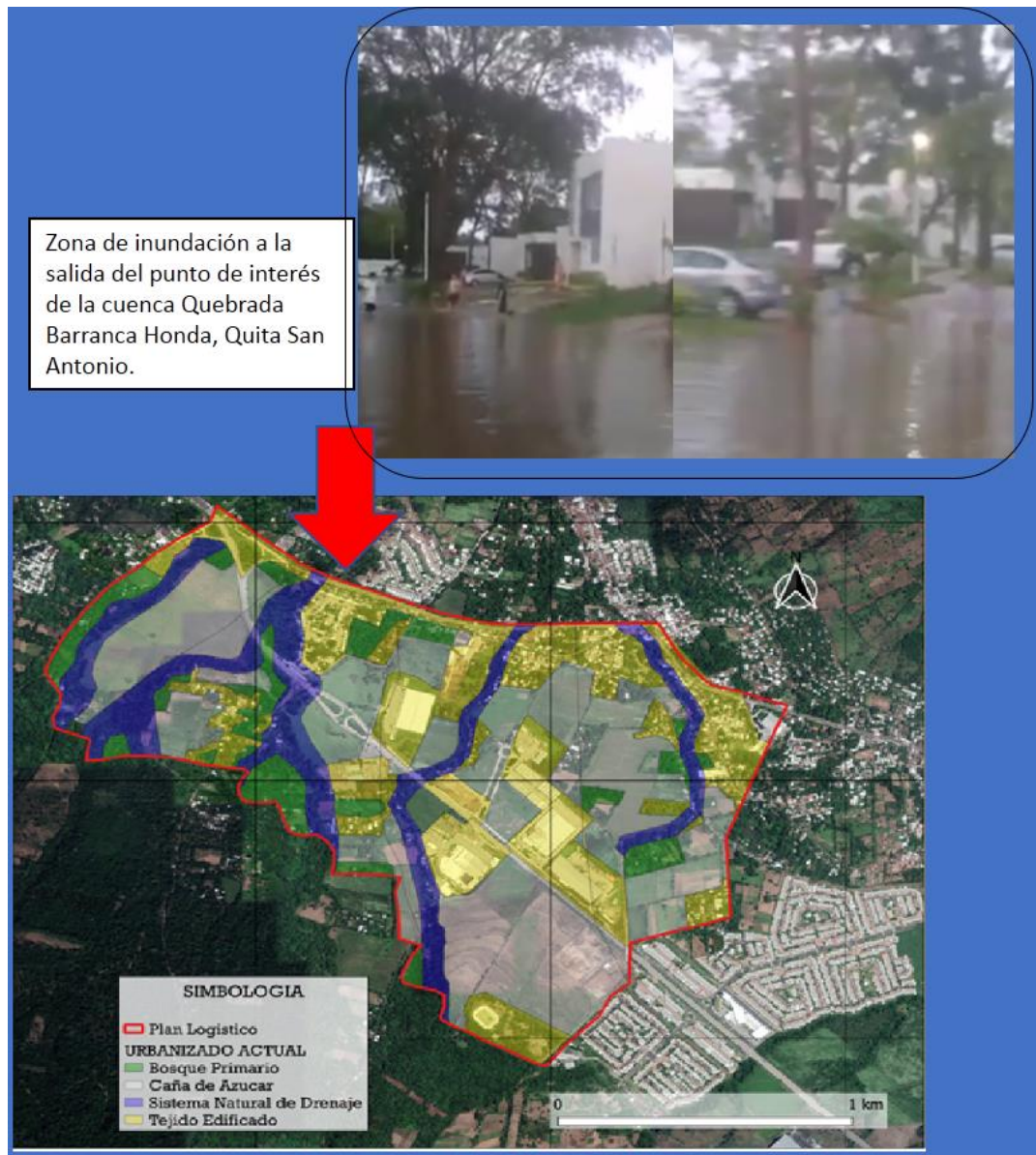
Figura 6.2 Ubicación exacta de inundación ocurrida por la tormenta Tropical Amanda en el punto de interés de la cuenca Quebrada El Tanque [Fuente: Elaboración propia, para la investigación de tesis de “Efectos de los sistemas detención de aguas lluvias en el Plan de Desarrollo Logístico Nejapa”].]
