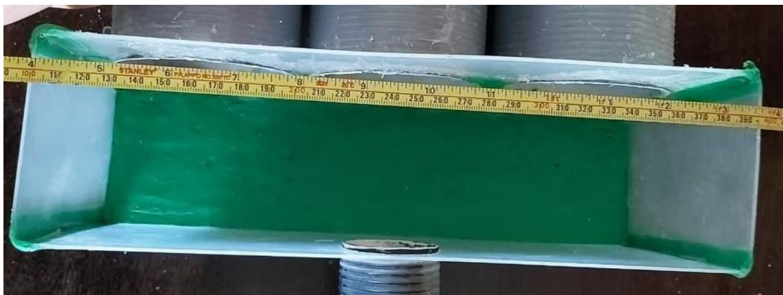
Figura 5.24 Dimensión de caja colectora de entrada, longitud más larga de 295mm del sistema de detención de aguas lluvias escala 1:20 [Fuente: Elaboración propia].
