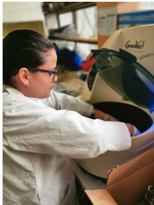
Figura N°45. Las muestras se concentran en Equipo Genevac Plus
