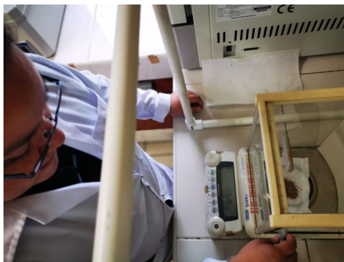
Figura N°37. Pesado de trilla de café para proceder a la extracción de metabolitos
