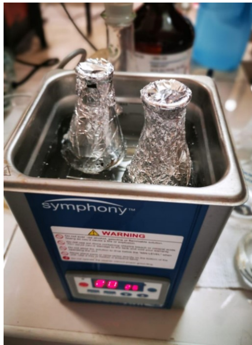
Figura N°41. Muestras en ultrasonido para extracción de metabolitos a analizar.
