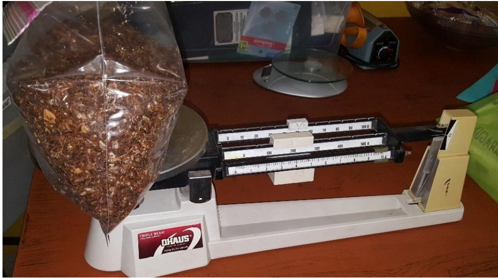
Figura N°32. Pesado de muestra (trilla de café) en Balanza granataria.
