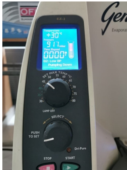
Figura N°44. Configuración de equipo Genevac con las condiciones para su funcionamiento.
