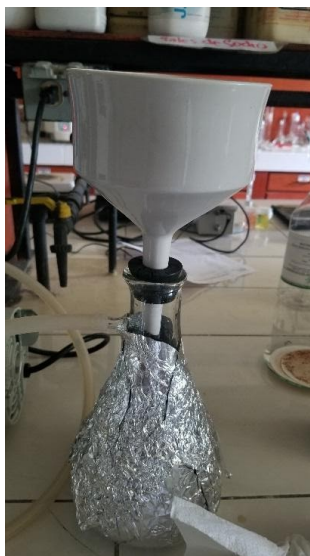
Figura N°42. Recuperación del extracto, utilizando bomba al vacío
